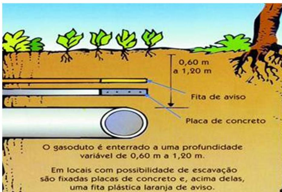
**Esquema de instalação da Rede de Distribuição de Gás Natural**
