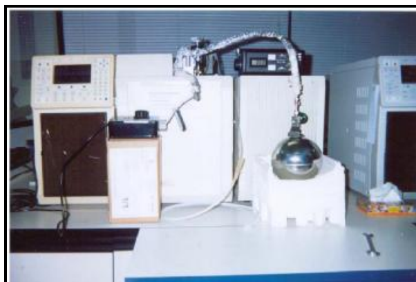
Cromatógrafo e canister acoplado para análise dos COVs.
