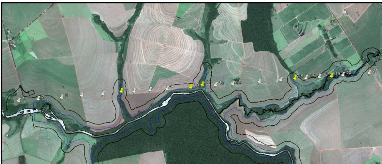
**Figura 37 – Localização das torres de alta tensão na área de influência da PCH, a linha azul indica a delimitação do reservatório e a preta da ADA, que inclui reservatório e sua área de preservação permanente.**
