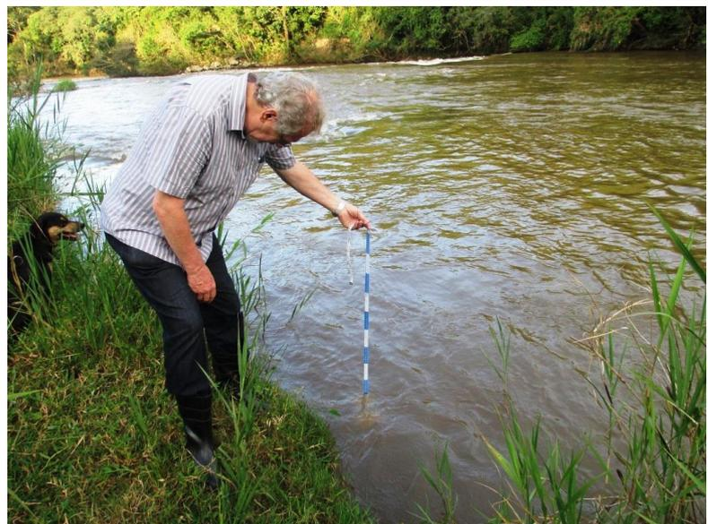
Figura 19. Coleta d'água para exame incluiu leitura do disco de Secchi
