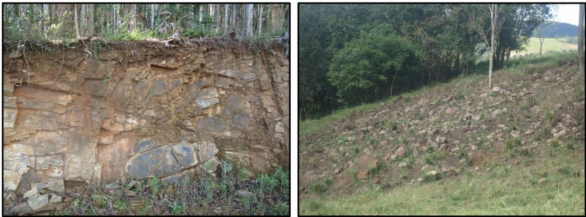
**Figura 26 – Solo residual sobre as rochas básicas (à esquerda). Depósitos coluvionares em encosta no entorno do empreendimento (à direita).**
