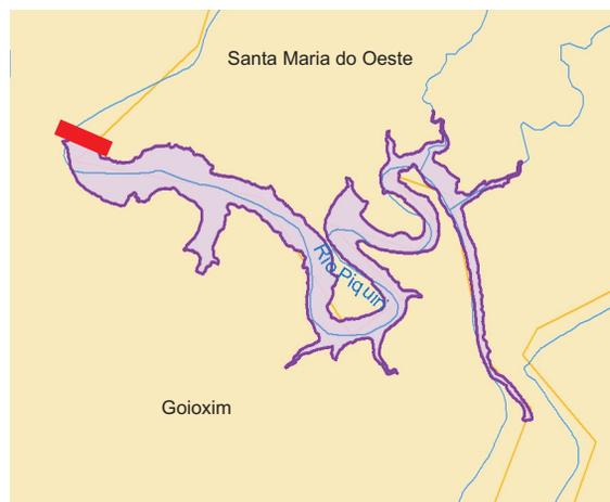
**Tomada d'água:** é a parte da usina que vai pegar a água do reservatório e desviá-la para o túnel de adução. Terá 17 m de largura e 13 m de altura e funcionará mais ou menos como um ralo de pia com controle da quantidade de água que pode passar. Veja a parte marrom.
