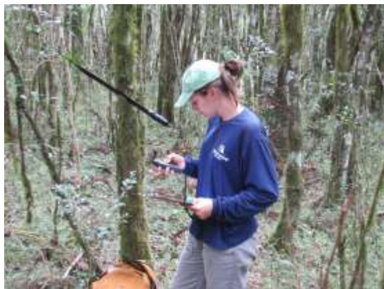
Figura 6.21: Georreferenciamento da parcela com GPS.
