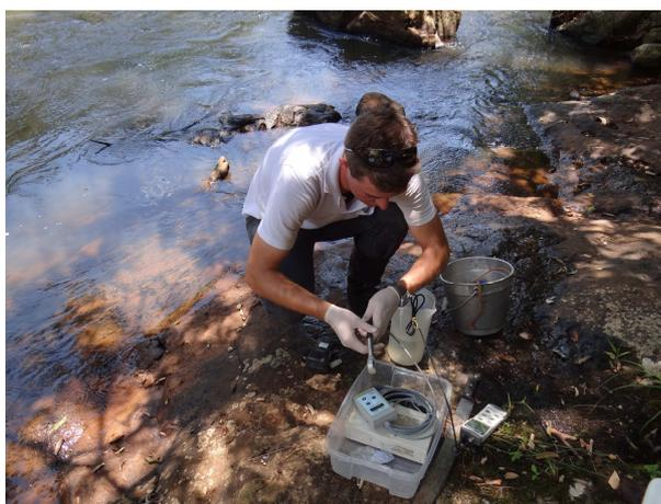
FOTO 79 – USO DE SONDA MULTIPARÂMETRO IN LOCO
