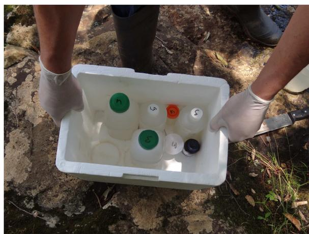
FOTO 80 – ACONDICIONAMENTO DE AMOSTRAS EM CAIXAS TÉRMICAS
