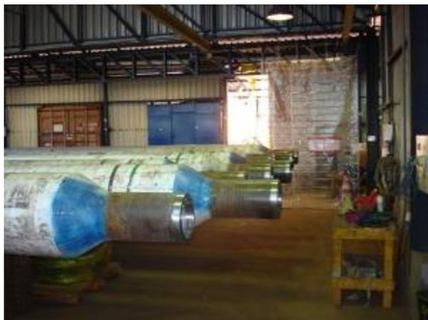
**Figura 2.29 – Área de posicionamento e acabamento das pontas dos tubos**
