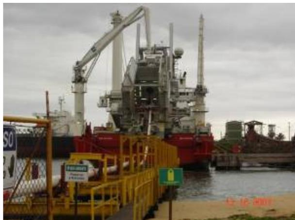
Figura 2.34 – Processo de carregamento dos dutos para embarque no navio (“*spooling*”)
