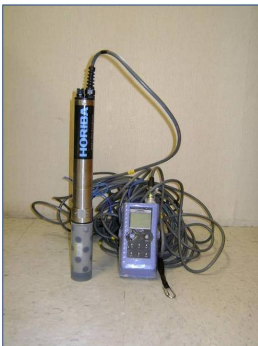
**Figura 4.136 – Sonda multiparâmetros Horiba modelo U-22 utilizada na medição de temperatura, pH, condutividade e oxigênio nas áreas de AID e ADA do empreendimento Subsea7**
