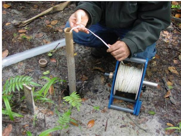
**Figura 4.91 – Vista da sondagem P05 tendo ao lado o medidor de nível da água subterrânea**
