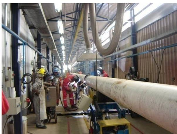
**Figura 2.31 – Processo de solda elétrica nos tubos**
