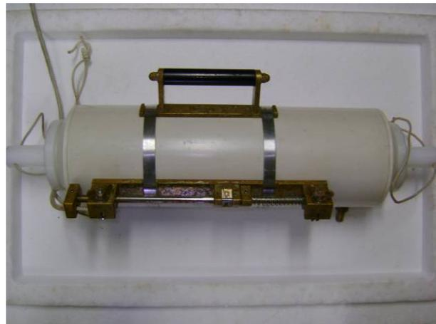
**Figura 4.138 – Garrafa de Van Dorn utilizada na coleta em diferentes profundidades nas áreas de AID e ADA do empreendimento Subsea7**
