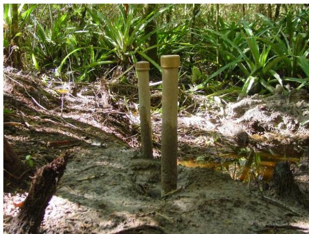
**Figura 4.92 – Tubos de revestimento sobressaindo-se do terreno no local da sondagem P14. O tubo de maior diâmetro corresponde ao poço usado para coleta de amostras de água do aquífero freático**
