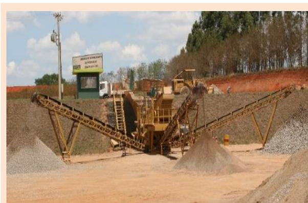
FIGURA 60 – VISTA GERAL DO BRITADOR DE RESÍDUOS DA CONSTRUÇÃO CIVIL.
