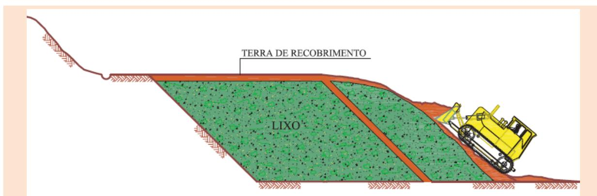
FIGURA 21 - FORMAÇÃO DAS CÉLULAS (COBERTURA COM SOLO)
