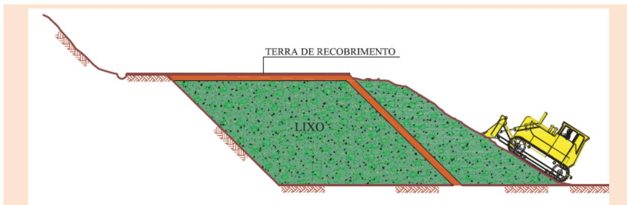
FIGURA 20 - FORMAÇÃO DAS CÉLULAS (COMPACTAÇÃO DA RAMPA)
