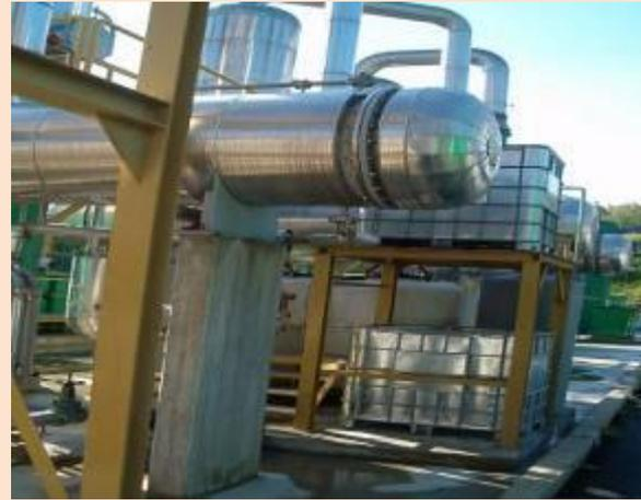
FIGURA 47 - CONDENSADOR
