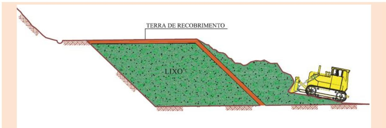
FIGURA 19 - FORMAÇÃO DAS CÉLULAS (FORMAÇÃO DA RAMPA)
