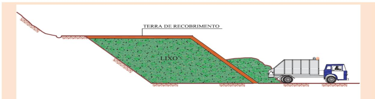
FIGURA 18 – FORMAÇÃO DAS CÉLULAS (DESCARREGAGEM DE RESÍDUOS)
