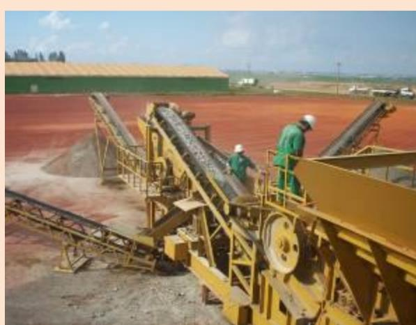
FIGURA 61 – SISTEMA BRITADOR DE RCC
