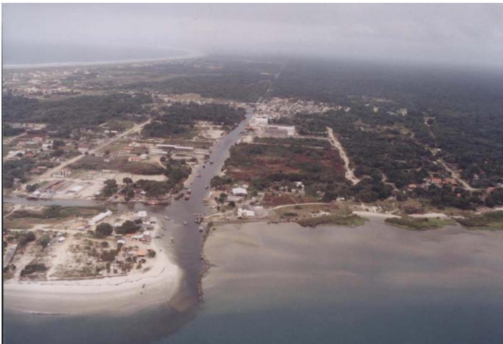
**Figura 3.29. Embocadura do Rio Olho d'Água em Pontal do Paraná Assoreada pelos Sedimentos, Causando Diminuição na Capacidade de Drenagem.**
