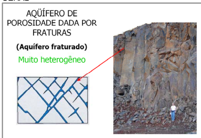
FIGURA 9 – FORMA DE CIRCULAÇÃO E ARMAZENAMENTO DE ÁGUA NO AQUIFERO SERRA GERAL
