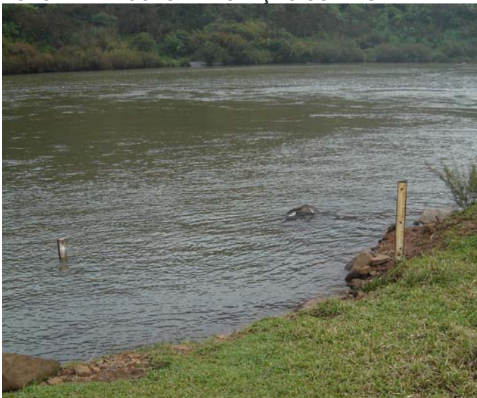
FOTO 11 – RÉGUAS DA ESTAÇÃO USINA SANTA MARIA – SALTO CURUCACA
