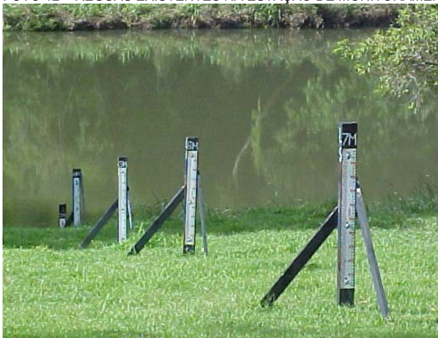
FOTO 12 – RÉGUAS EXISTENTES NA ESTAÇÃO DE MONITORAMENTO GUARAPUAVINHA
