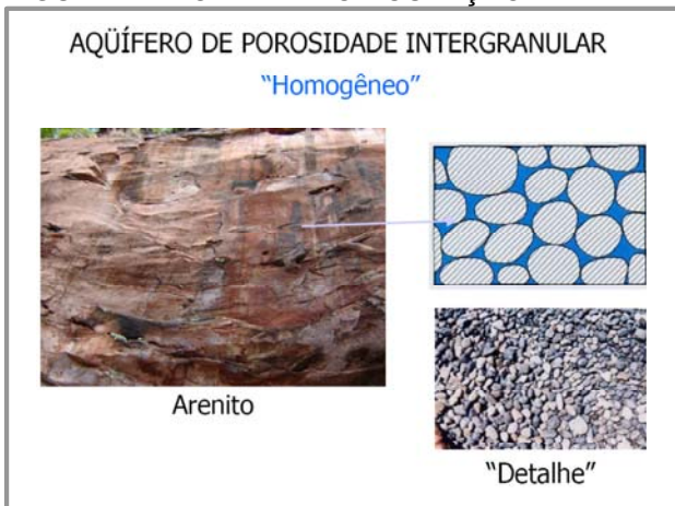
FIGURA 7 – FORMA DE CIRCULAÇÃO E ARMAZENAMENTO DE ÁGUA NO AQÜÍFERO GUARANI
