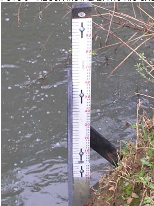
FOTO 8 – RÉGUA INSTALADA NO RIO CASCAVEL
