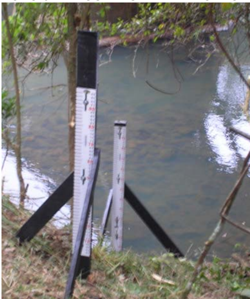
FOTO 6 – RÉGUA INSTALADA NO RIO BANANAS
