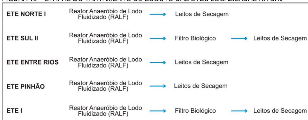
FIGURA 18 – ETAPAS DO TRATAMENTO DE ESGOTO DAS ETES LOCALIZADAS NA BHJ
