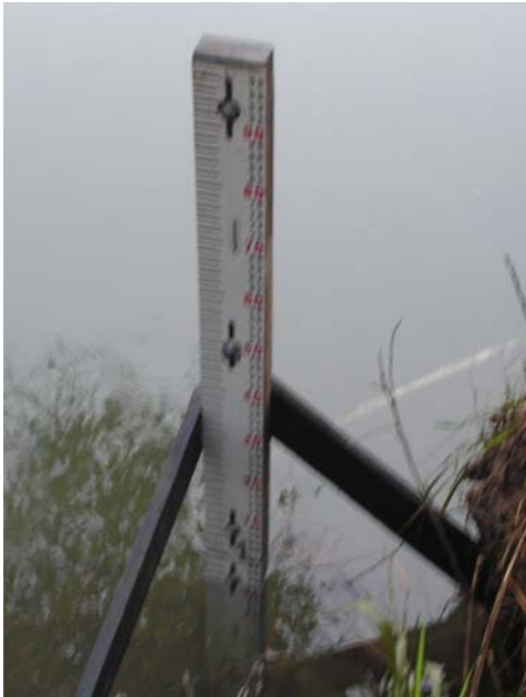
FOTO 13 – RÉGUA INSTALADA A MONTANTE DO RESERVATÓRIO DA UHE SANTA CLARA
