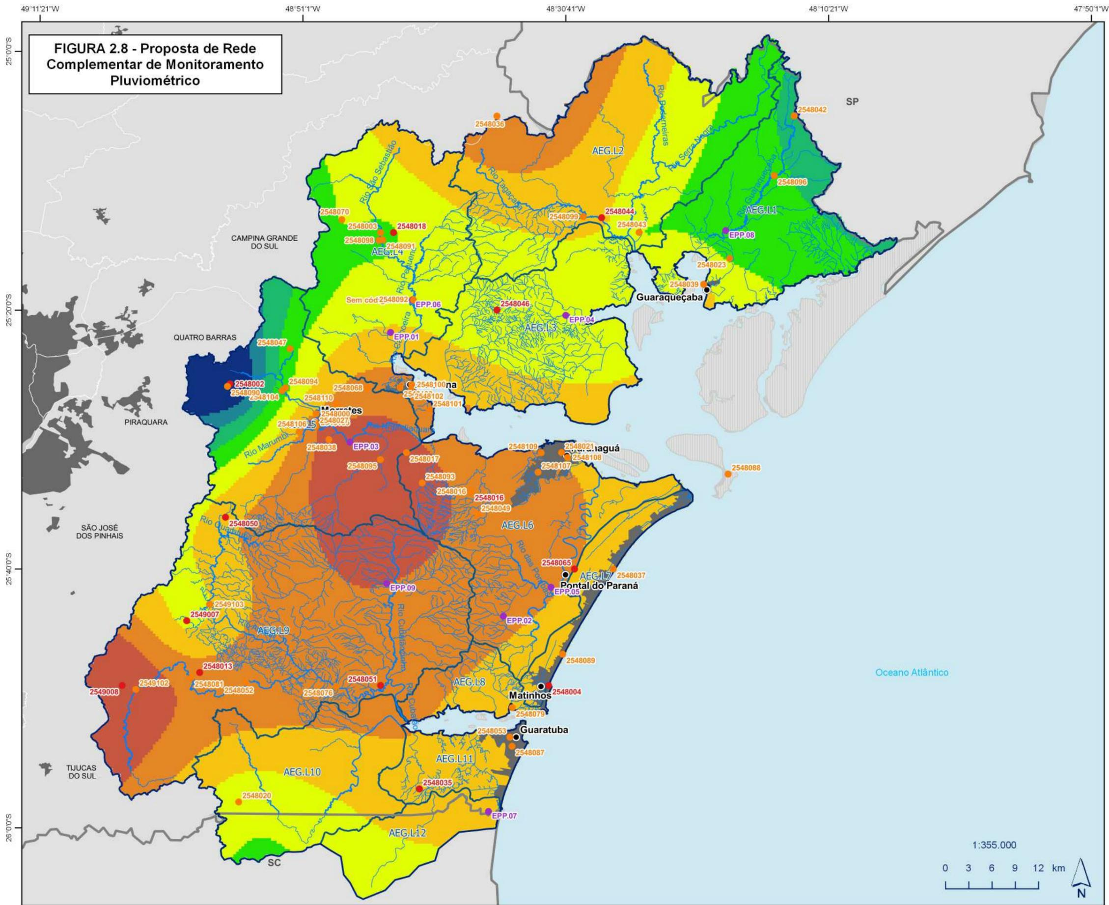
**FIGURA 2.8 - Proposta de Rede Complementar de Monitoramento Pluviométrico**
