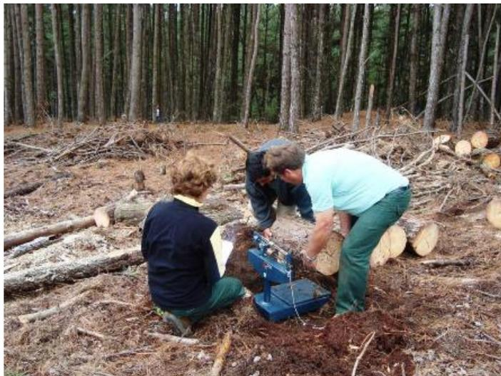
Figura 6: Pesagem do fuste com a casca em balança mecânica.
