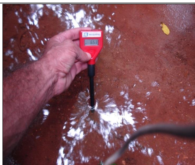
Coleta de amostras de água para análise e medição de parâmetros físico-químicos
