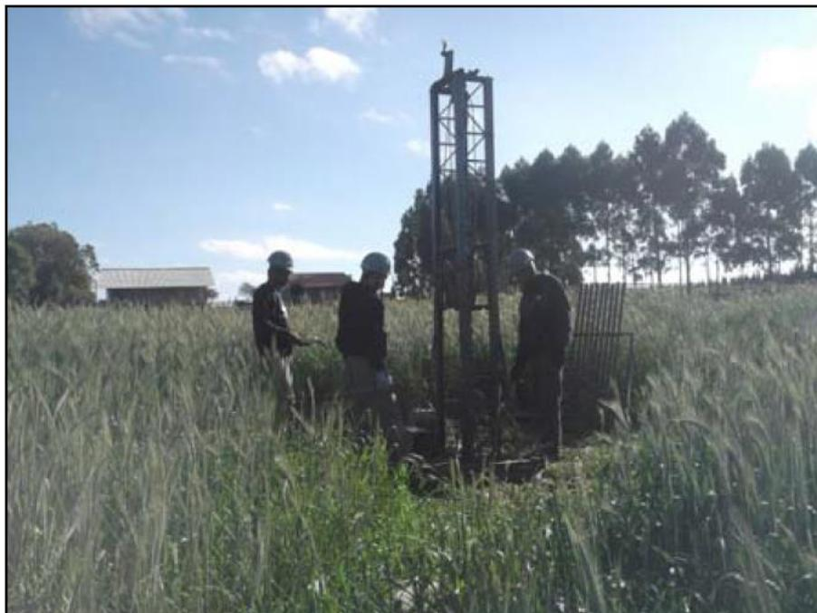
**Figura 4.19: Sondagem a trado mecanizado.**
