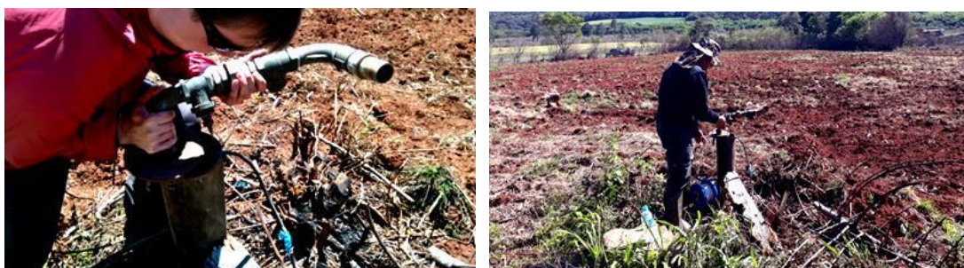
Figura 28: Boca do poço (esquerda) e medição do NA (direita).
