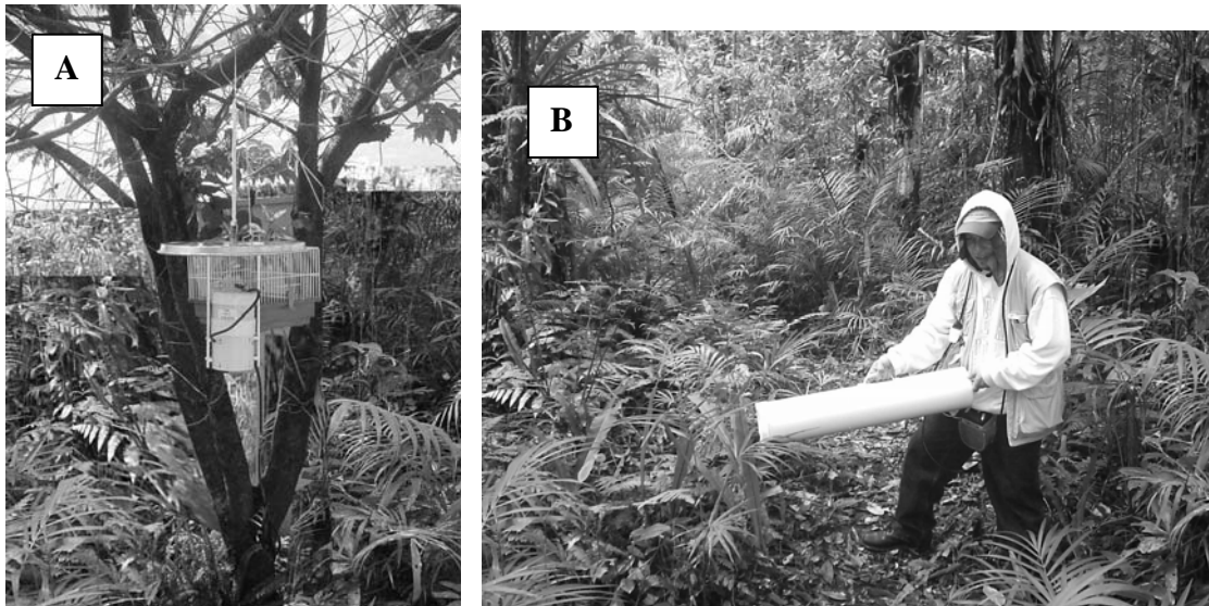
Figura 3. A. Aspecto geral da armadilha CDC-m instalada na área de mata da Floresta Estadual do Palmito, Estado do Paraná, Brasil. B. Aspecto do aspirador de Nasci com o operador protegido da ação dos Culicidae e de outros insetos.
