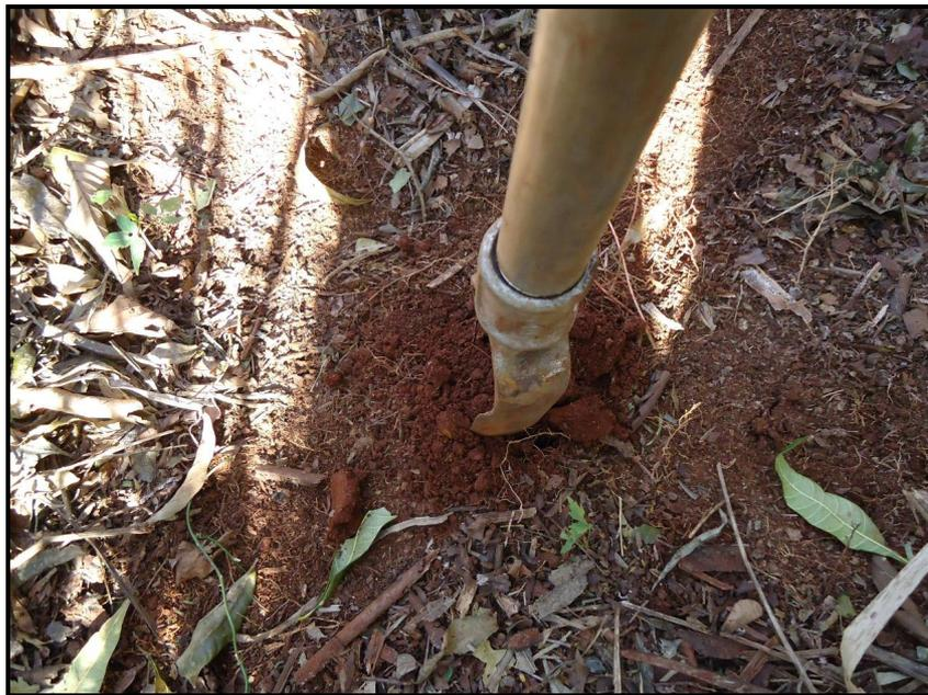
**Figura 72 – Execução da sondagem ST-03.**
