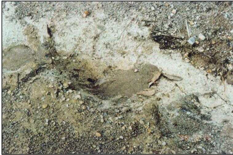
**Figura 14. Saprólito formando substrato da estrada.**
