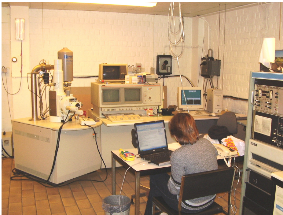
Figura 10 - Equipamento utilizado na análise de M.E.V. - E.D.X.
