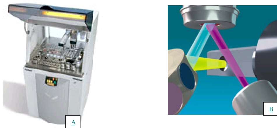
Figura 14 - Equipamento de Fluorescência de raios-X (A) e a geometria tridimensional (B)
