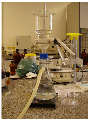
Figura 8 - Esquema de filtragem de água para análise em E.D.F.R.X e M.E.V-E.D.X.
