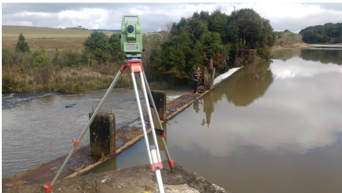
Figura 22: Levantamento trigonométrico na barragem
