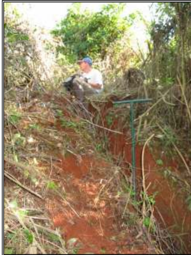
Foto IV.05 - Perfil Exposto de NITOSSOLO VERMELHO Eutroférico em Vossoroca Existente no Interior do Parque (fonte: E. Oliveira, 2002)
