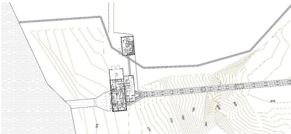
A casa de força é composta por três ambientes principais em planta: sala de máquinas, sala de comando e pátio de descarga e duas formas construtivas distintas em
