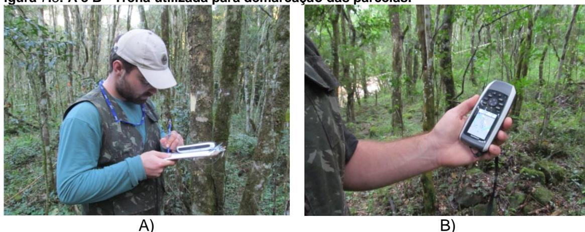
**Figura 7.4: A) Planilhas de campo – Anotações dos dados levantados no campo e B) GPS de mão utilizado para o georreferenciamento das parcelas no campo.**
