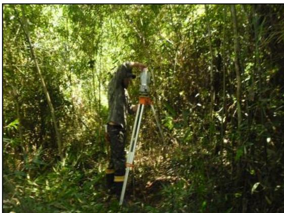
**Figura 6.21: Trabalhos topográficos instalação da estação total. Fonte: Construnível, 2015.**
