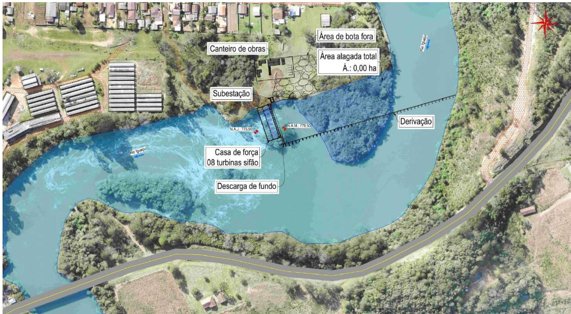
**Figura 4.1: Arranjo geral das estruturas da CGH Kuaraytu.**
