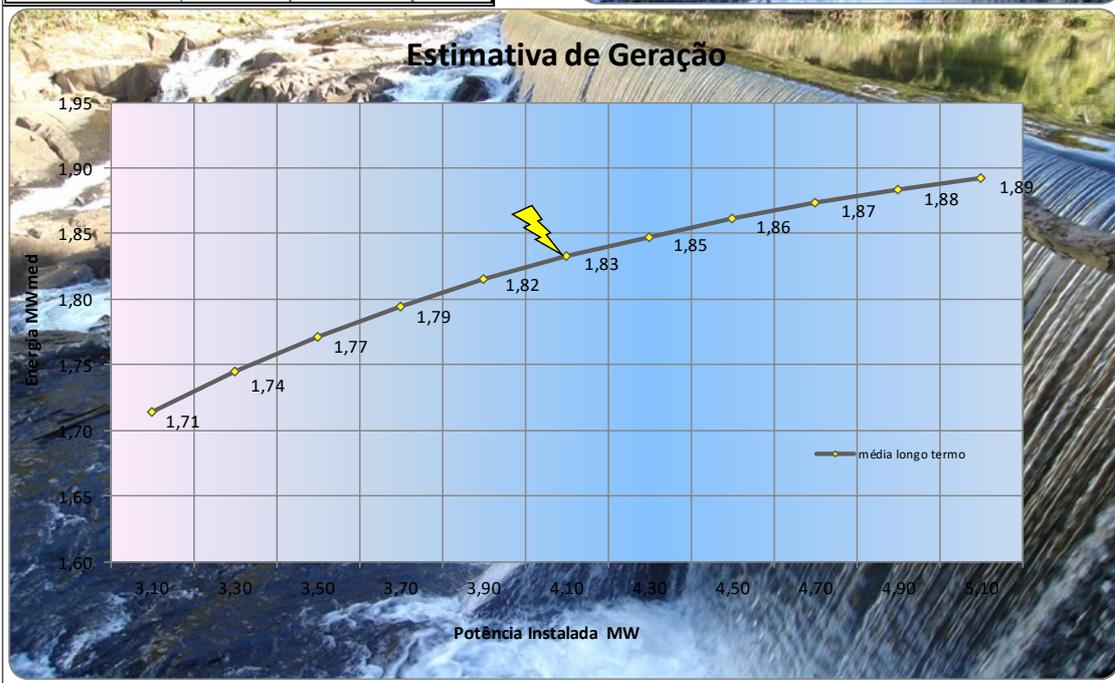
Figura 4.7: Motorização e resumo energético da CGH Kuaraytu.
