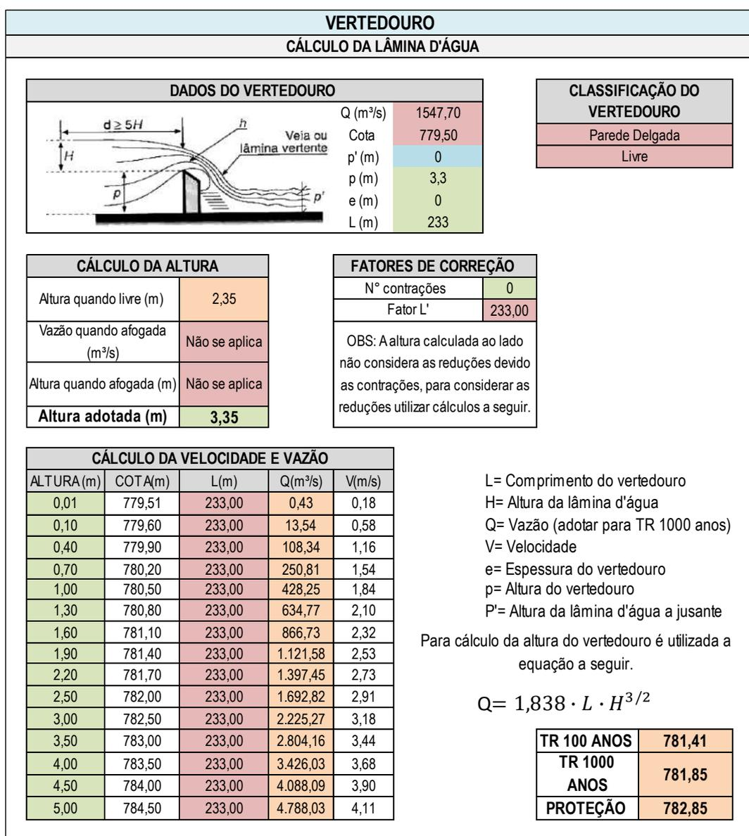
Figura 4.2: Dimensionamento e curva-chave do Vertedouro.
