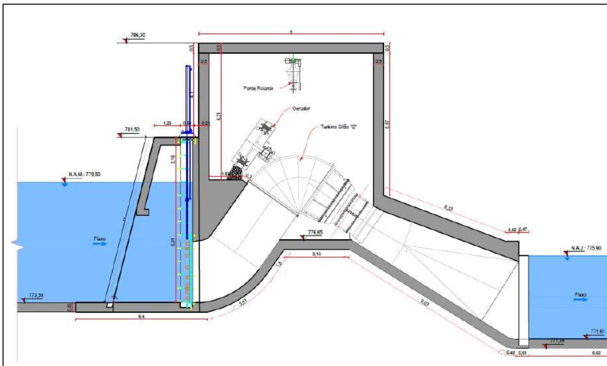
Figura 4.5: Ilustração do Modelo de turbina Tubular “S” Sifão, rotor Kaplan a ser utilizado na CGH Kuaraytu.
