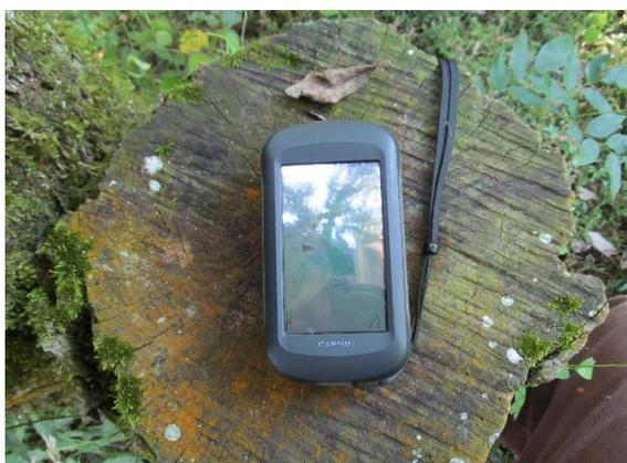
Figura 7.4: GPS de mão utilizado para o georreferenciamento das parcelas no campo.
