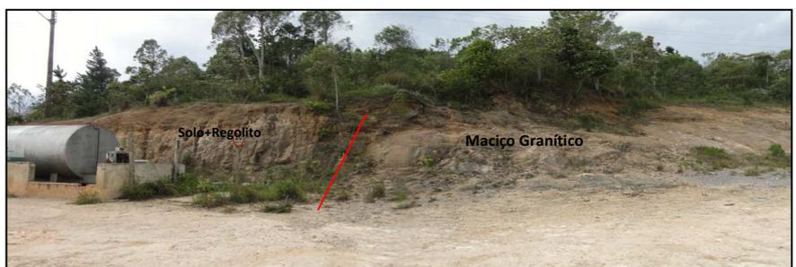
Foto tirada na continuação da anterior onde se observa a ocorrência lado a lado de manto de alteração (solo+regolito) e núcleos de granito levemente alterado, formando lajes resistentes.
