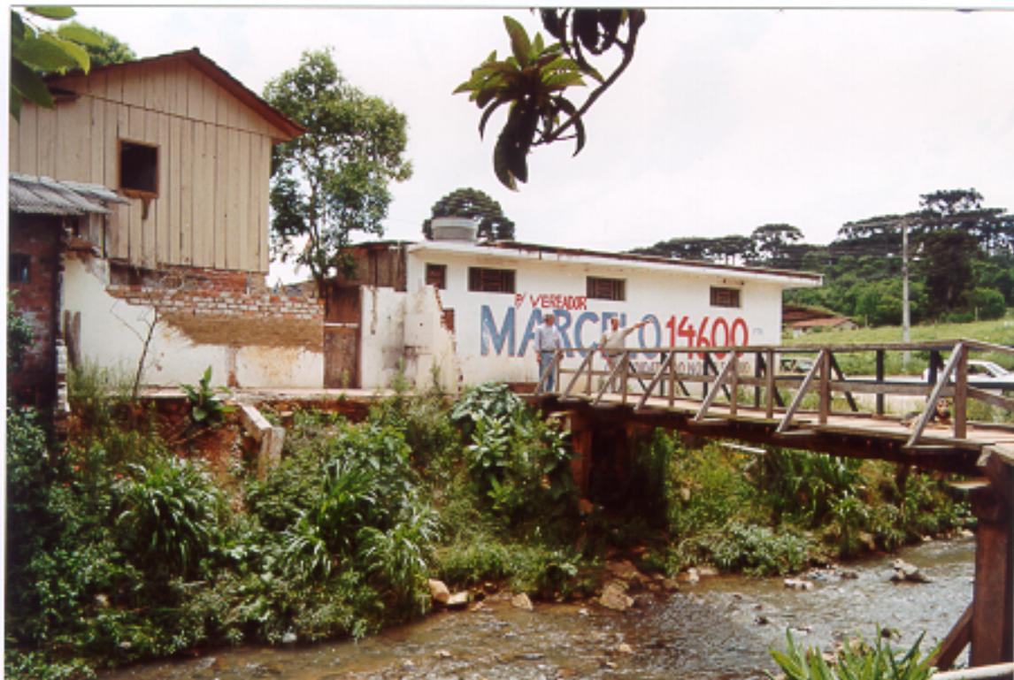
**F10.9.** Margem oposta da foto anterior, onde se vê evidências de destruição de moradias, provocada por erosão dos taludes marginais, devido à alta energia de escoamento das águas do córrego Mossunguê. Mancha de inundação CRT-107. Cenários de risco I e III.
