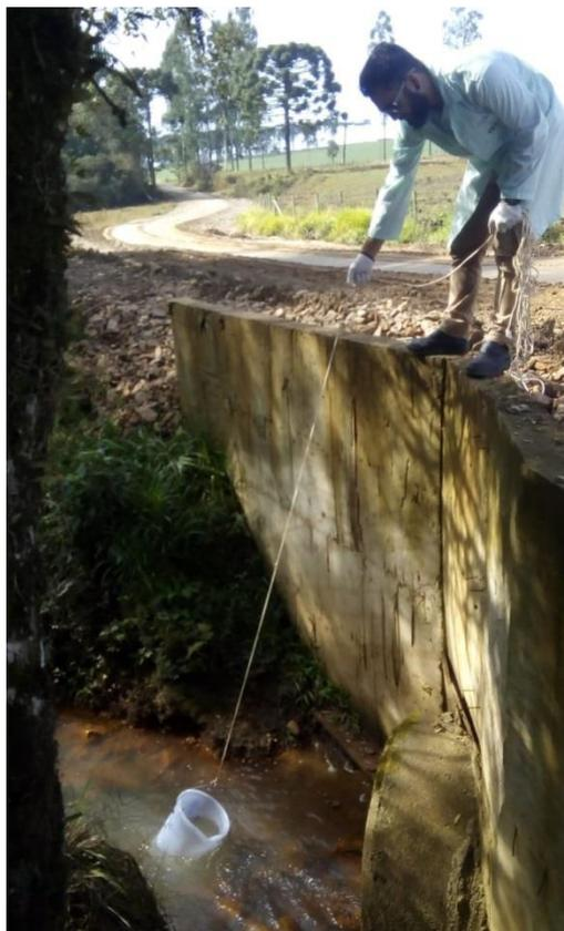
Figura 241: Técnico realizando a coleta da amostra de água superficial.
