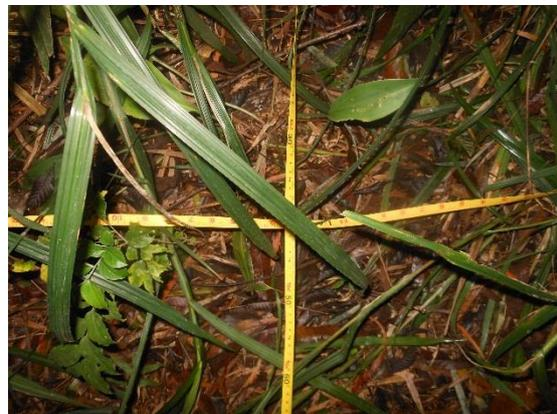
Figura 265: Método de demarcação da parcela durante o levantamento, trenas se cruzando no centro da UA.
