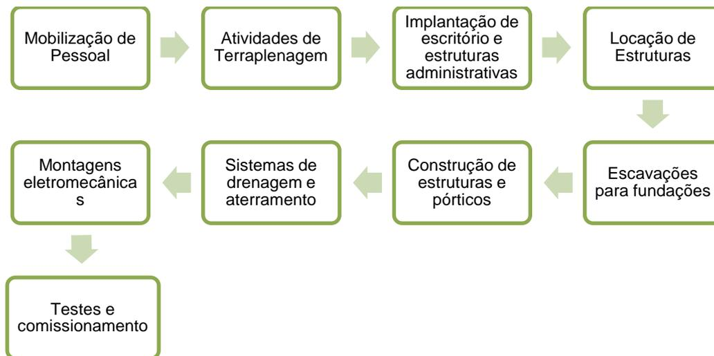
Figura 55: Atividades da construção de subestação.
