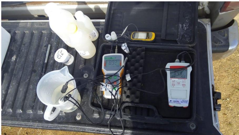
Figura 240: Materiais utilizados na coleta: frascos hermeticamente fechados para armazenamento das amostras e equipamentos de medição de pH e OD *in loco*.
