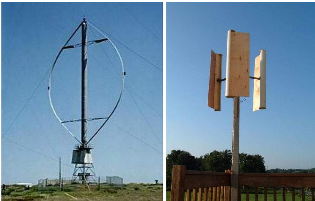
Figura 4 – Aerogeradores de eixo vertical do tipo Darrieus (esquerda) e Savonius (direita).
