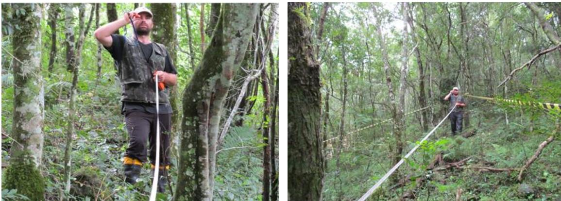
**Figura 4.58: Medição da altura das árvores utilizando o clinômetro eletrônico Haglöf.**
