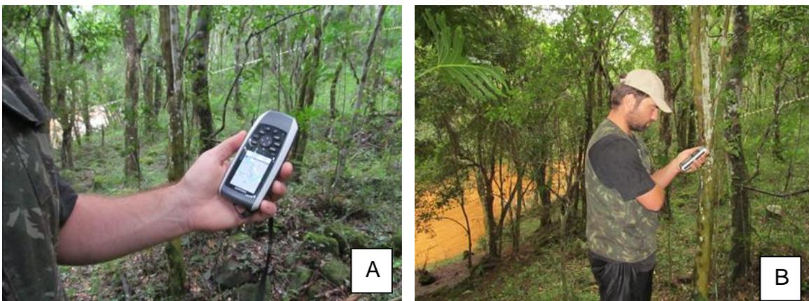
**Figura 4.54: A e B , GPS Garmin modelo GPSMap 78, utilizado para o georeferenciamento das parcelas no campo modelo.**
