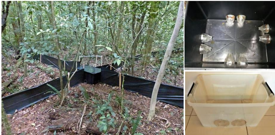
Figura 01 B. Imagens da armadilha com caixa central e caixas das extremidades.
