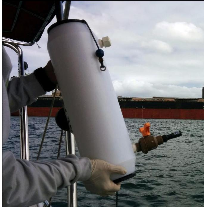
Figura 11. Garrafa amostradora do tipo *van Dorn*.
