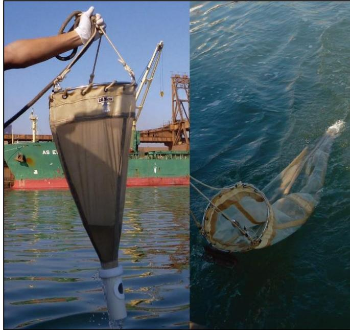
Figura 9. Rede cônica com malha de 20  $\mu\text{m}$ , utilizada para amostragem de fitoplâncton.
