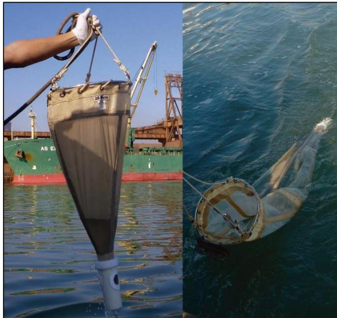
Figura 10. Rede cônica com malha de 20  $\mu\text{m}$ , utilizada para amostragem de fitoplâncton.
