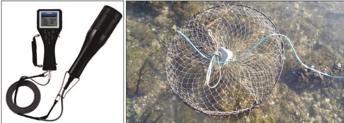
Figura 17. Sonda multiparâmetros e gaiola utilizada para coleta dos decápodes.
