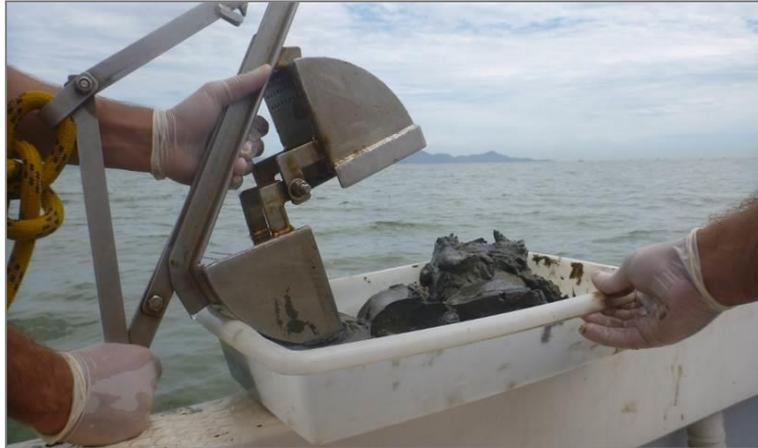
Figura 14. Amostrador do tipo *van Veen*, com área amostral de 0,02m<sup>2</sup>, utilizada para a coleta da macrofauna bentônica de substrato inconsolidado
