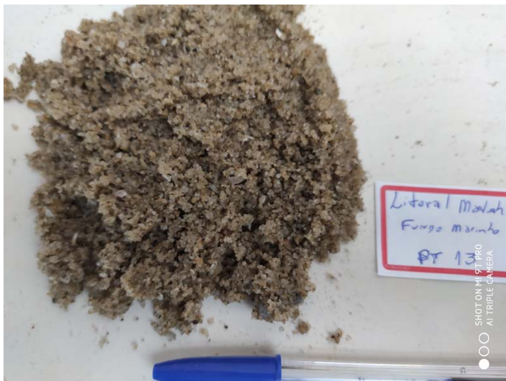
Foto 32 = Detalhe da granulometria média a grosseira dos sedimentos no PT-13 . Os pontos brancos são fragmentos de conchas e os pontos negros, minerais pesados. Foto do autor.
