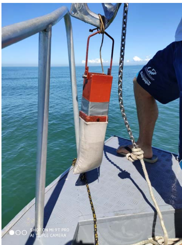
Foto 03 = Draga de arrasto de Gibbs, recuperada com a carga de sedimentos amostrada e o tipo de sedimento amostrado, transferido para um saco de plástico reforçado. Foto do autor.
