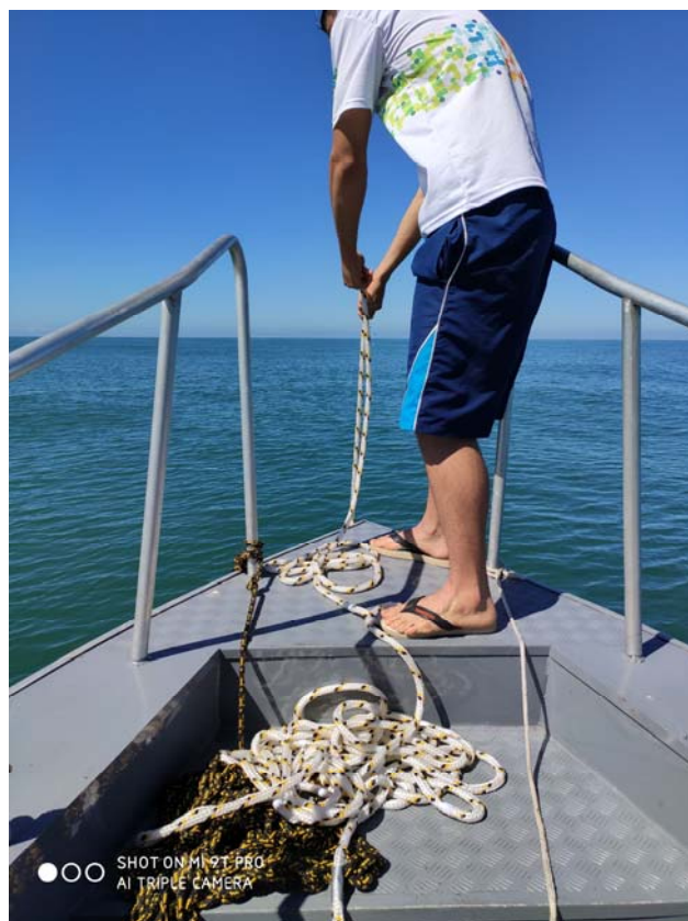
Foto 02 = Dragas de arrasto de Gibbs, presa por uma corda graduada a cada metro, preparada para descida no mar e após, o resgate, quando a mesma havia amostrado sedimentos de fundo. O técnico se encontra de máscara, por obrigação legal, em virtude da pandemia de Corona vírus. Foto do autor.
