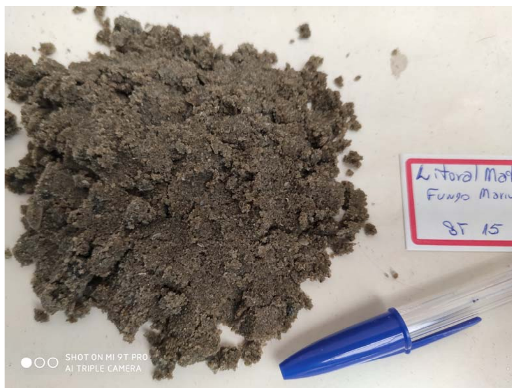
Foto 36 = Detalhe da granulometria fina dos sedimentos no PT-15 . Os pontos brancos são fragmentos de conchas e os pontos negros, minerais pesados. Foto do autor.
