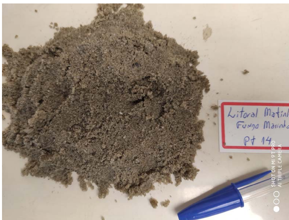
Foto 34 = Detalhe da granulometria média a fina dos sedimentos no PT-14 . Os pontos brancos são fragmentos de conchas e os pontos negros, minerais pesados. Foto do autor.
