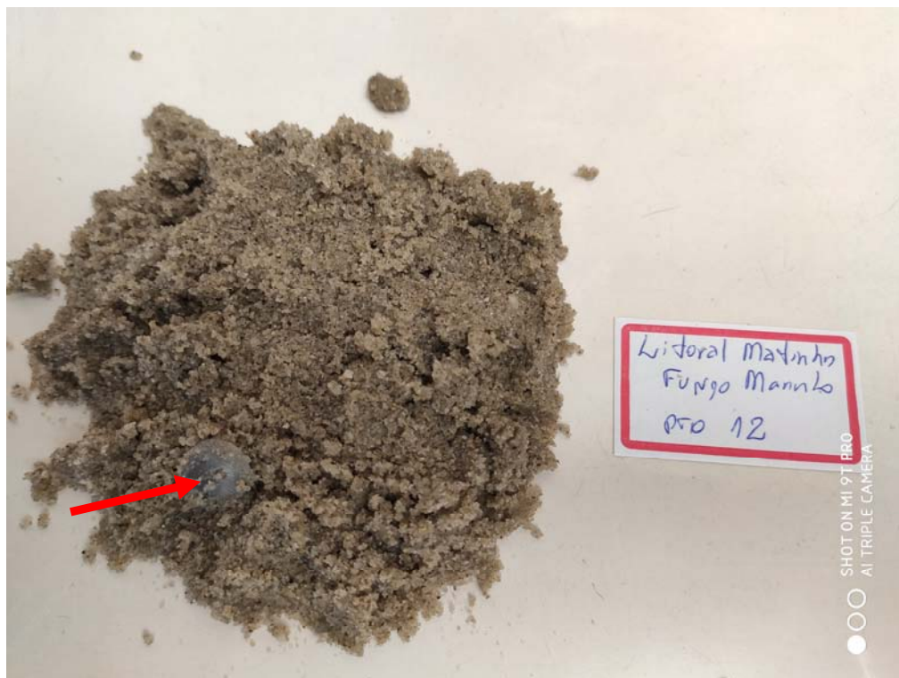
Foto 30 = Detalhe da granulometria média a fina dos sedimentos no PT-12 . A porção superior de uma concha está destacada pela seta. Foto do autor.
