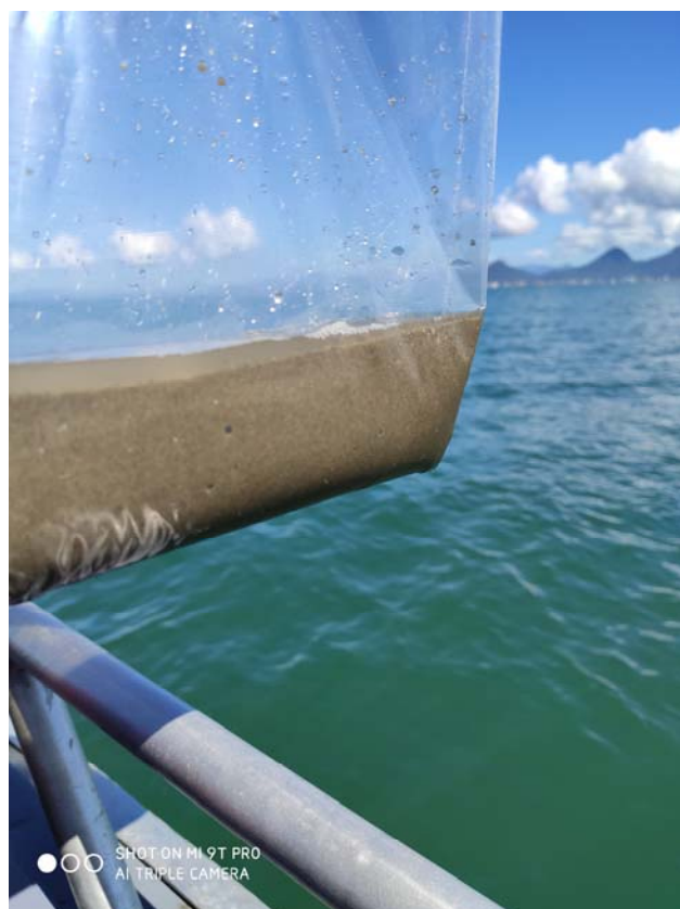
Foto 03 = Draga de arrasto de Gibbs, recuperada com a carga de sedimentos amostrada e o tipo de sedimento amostrado, transferido para um saco de plástico reforçado. Foto do autor.
