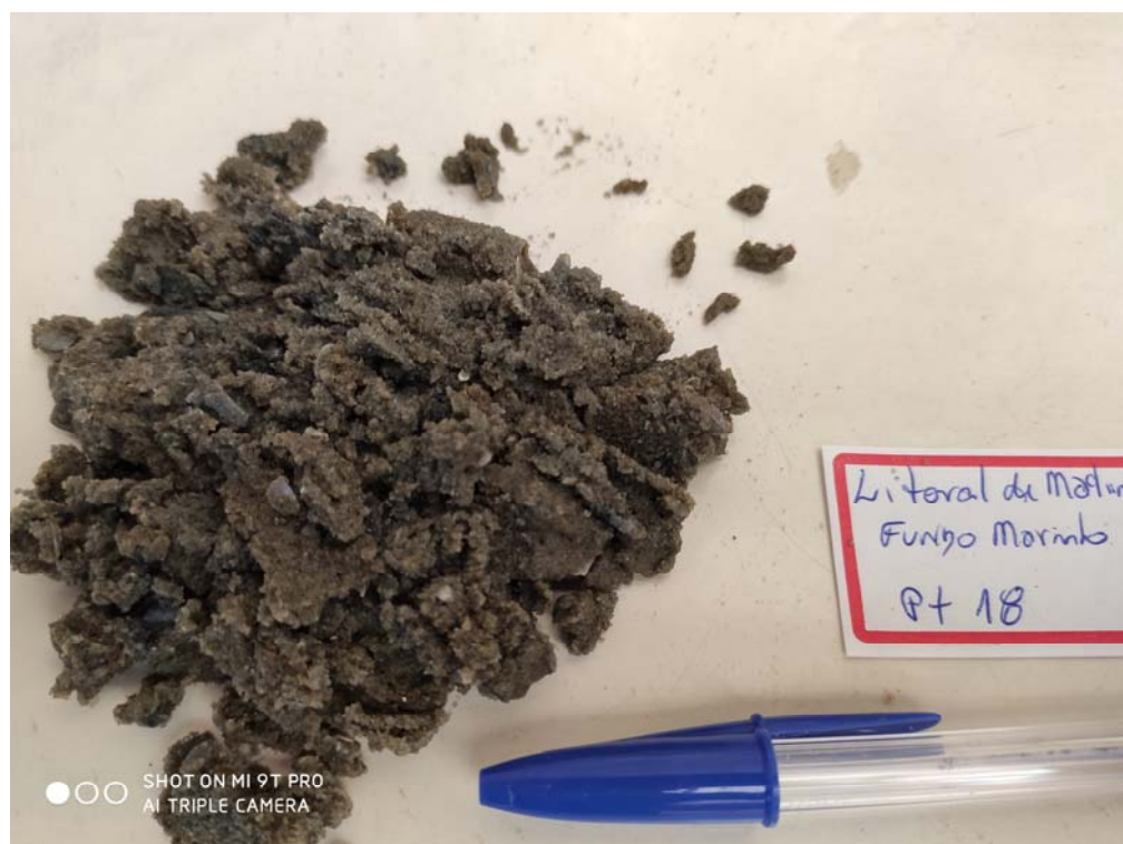
Foto 42 = Detalhe da granulometria fina dos sedimentos no PT-18 . Os pontos brancos são fragmentos de conchas e os pontos negros, minerais pesados. Foto do autor.
