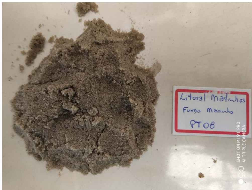
Foto 22 = Detalhe da granulometria fina dos sedimentos no PT-08 . Os pontos brancos são fragmentos de conchas e os pontos negros, minerais pesados. Foto do autor.
