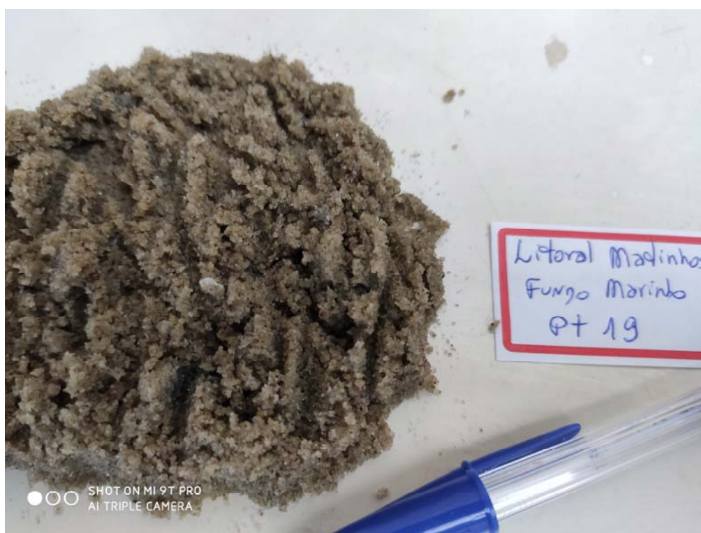
Foto 44 = Detalhe da granulometria fina dos sedimentos no PT-19 . Os pontos brancos são fragmentos de conchas e os pontos negros, minerais pesados. Foto do autor
