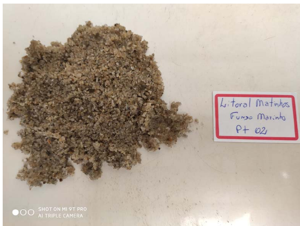
Foto 10 = Detalhe da granulometria média dos sedimentos no PT-02 . Os pontos brancos são fragmentos de conchas e os pontos negros, minerais pesados. Foto do autor.
