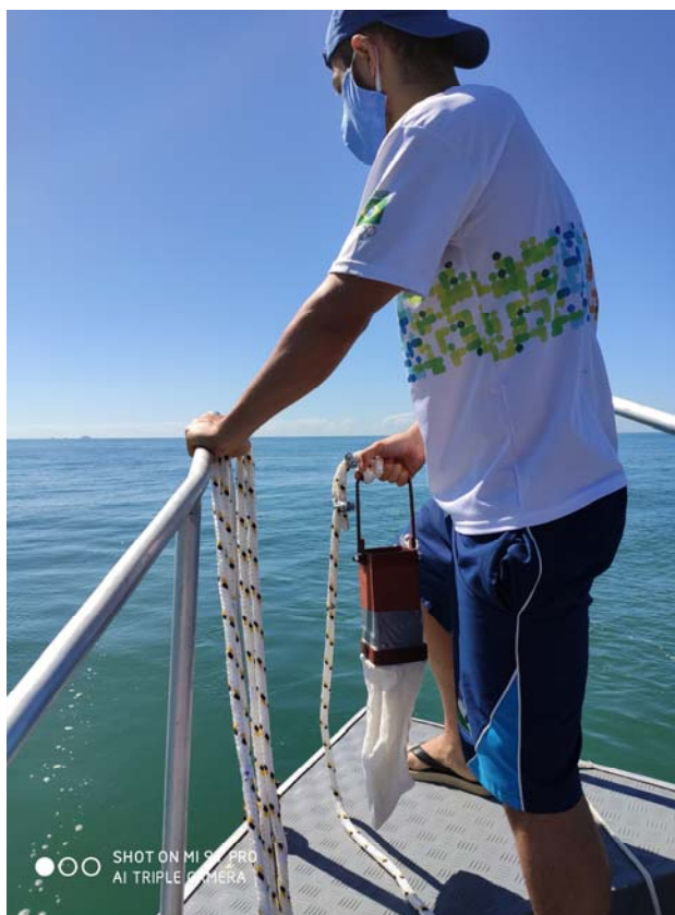
Foto 02 = Dragas de arrasto de Gibbs, presa por uma corda graduada a cada metro, preparada para descida no mar e após, o resgate, quando a mesma havia amostrado sedimentos de fundo. O técnico se encontra de máscara, por obrigação legal, em virtude da pandemia de Corona vírus. Foto do autor.
