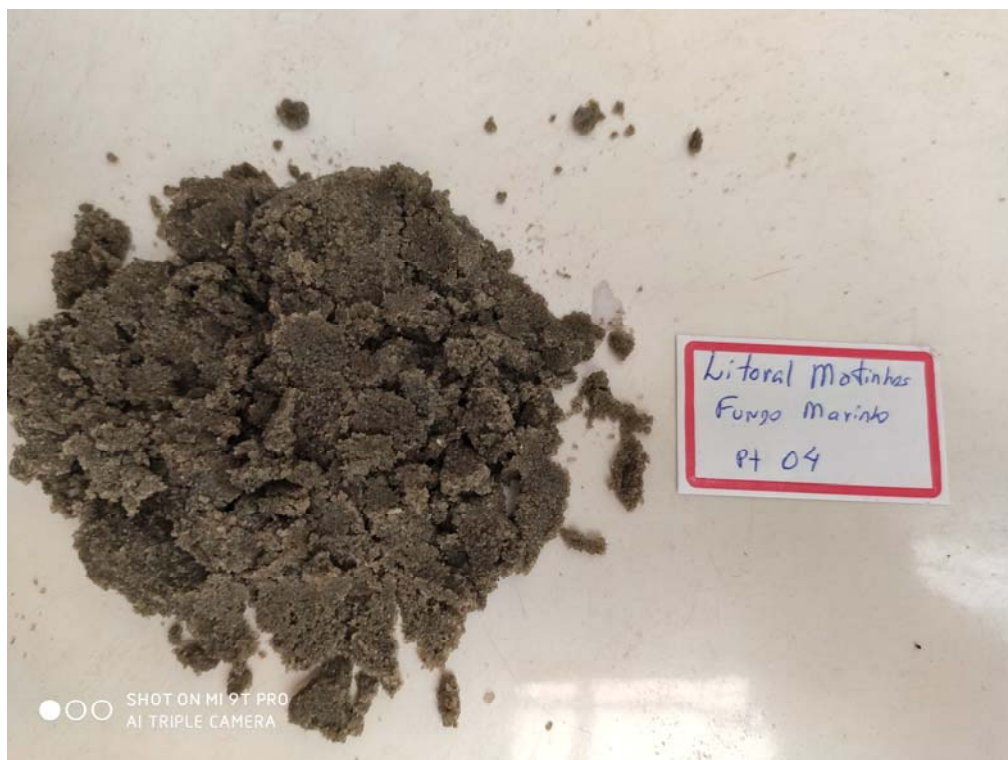
Foto 14 = Detalhe da granulometria fina a muito fina dos sedimentos no PT-04 . Os pontos brancos são fragmentos de conchas e os pontos negros, minerais pesados. Foto do autor.
