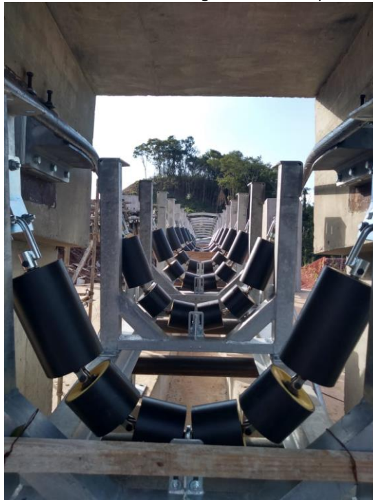
Foto 6 – Traçado correia transportadora
