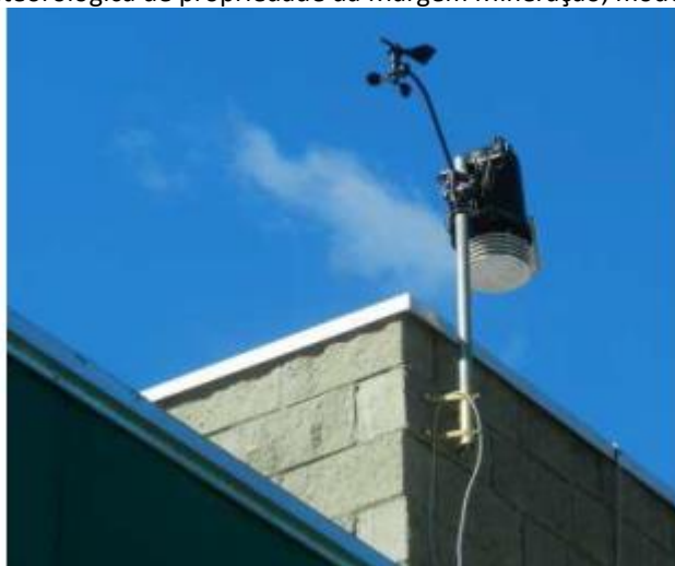
Figura 6 – Estação meteorológica de propriedade da Margem Mineração, modelo Davis Vantage Pro2
