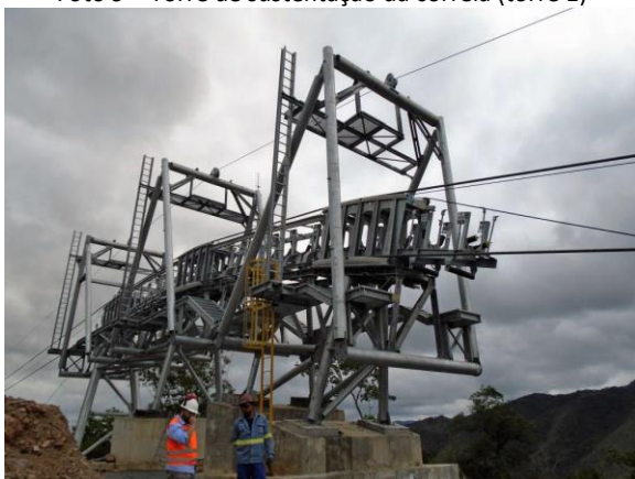
Foto 11 – Guias e roletes de carga – correia transportadora
