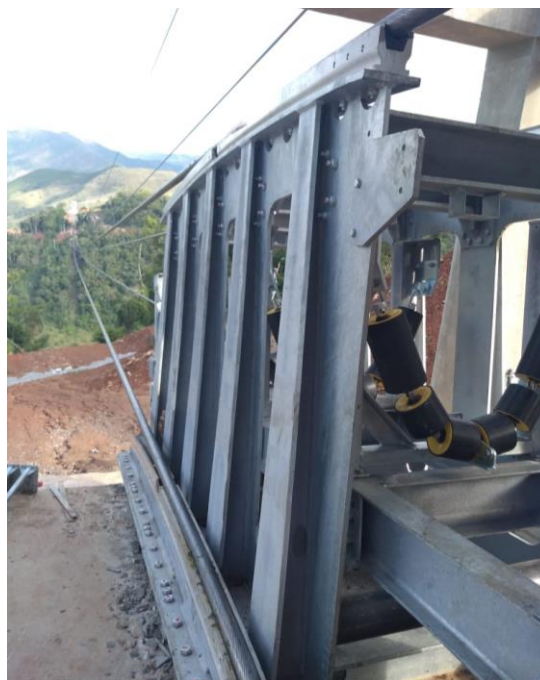
Foto 12 – Cossinete suporte de roletes de carga – correia transportadora
