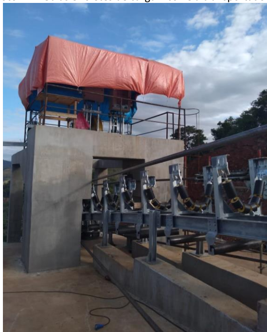
Foto 11 – Guias e roletes de carga – correia transportadora
