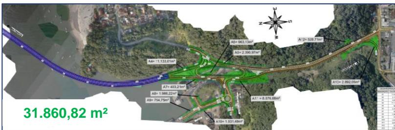
A estimativa dos valores das áreas a serem desapropriadas foi obtida a partir do projeto geométrico das alternativas 3, 4 e 6, sendo adotado a tabela de custos unitários básicos de construção do SINDUSCON-PR (SINDUSCON-PR, 2022), complementado com informações do site imovelweb (IMOVELWEB, 2022) de ofertas ao longo dos trechos do empreendimento.
