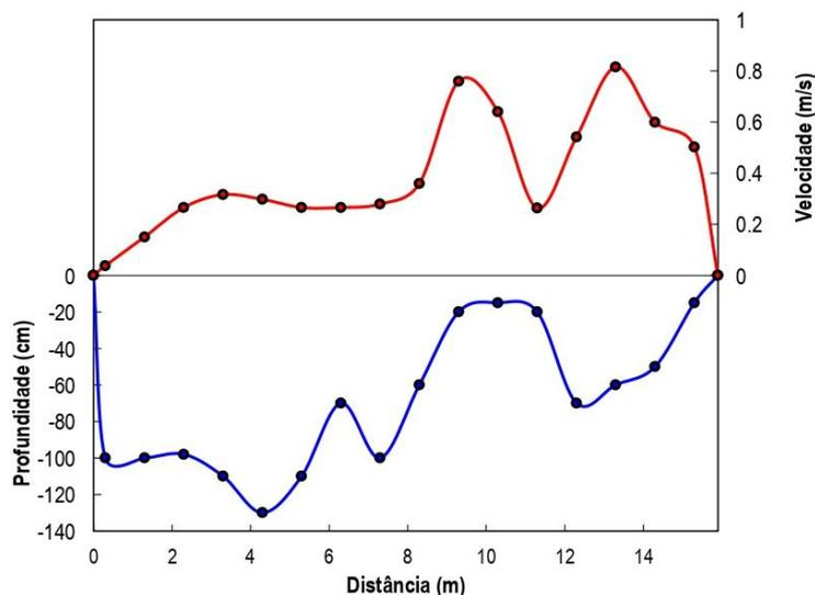
Figura 4: Velocidades observadas na seção de medição da estação CGH Maravilha - Ponto 2, em 07/07/2022.
