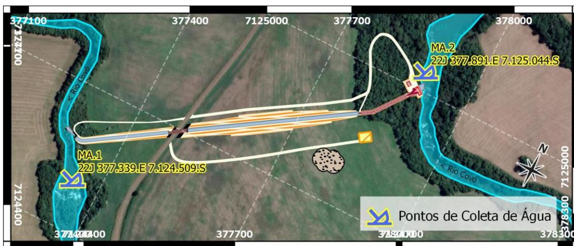
Figura 38 – Coordenadas dos pontos de coleta de água para ensaios.
