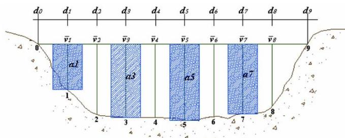
Figura 2: Esquema ilustrativo do método da meia-seção
