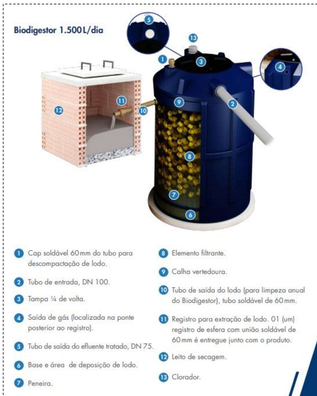
Figura 73 – Composição e modelo do Biodigestor 1.500 L/dia, conforme manual.
