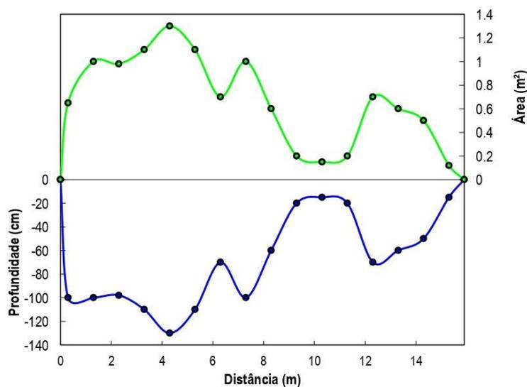
Figura 3: Seção transversal de medição da estação CGH Maravilha - Ponto 2, em 07/07/2022.
