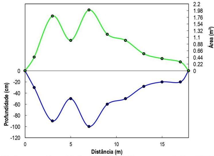
Figura 7: Seção transversal de medição da estação CGH Maravilha - entre pontos 7 e 8, em 07/07/2022.
