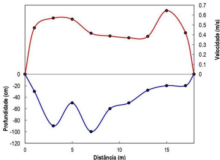
Figura 8: Velocidades observadas na seção de medição da estação CGH Maravilha - entre pontos 7 e 8, em 07/07/2022.
