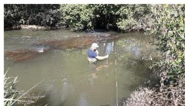
Figura 4: Medição de descarga líquida.
