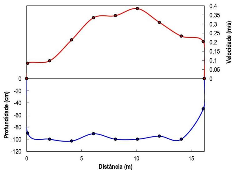
Figura 6: Velocidades observadas na seção de medição da estação CGH Maravilha - Ponto 4, em 07/07/2022.
