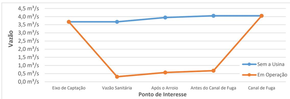
Figura 27 – Comparação das vazões sem a usina e se a usina estivesse em operação na data de 07/07/2022, liberando somente a vazão sanitária.
