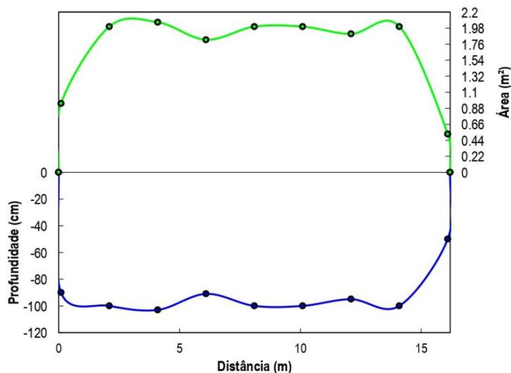
Figura 5: Seção transversal de medição da estação CGH Maravilha - Ponto 4, em 07/07/2022.
