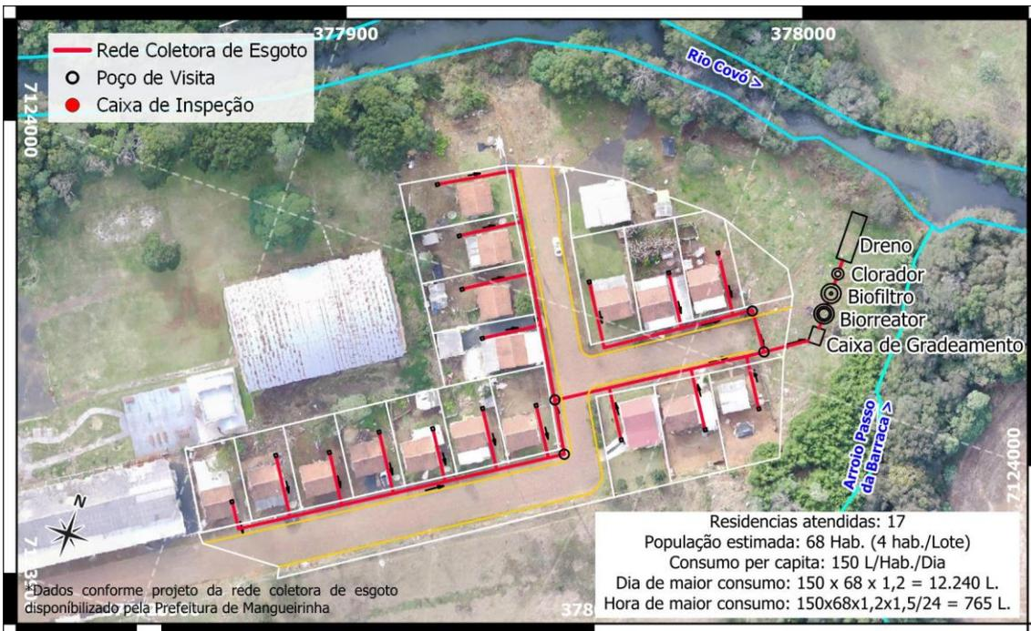
Figura 21 – Rede coletora de esgoto no distrito do Covó
