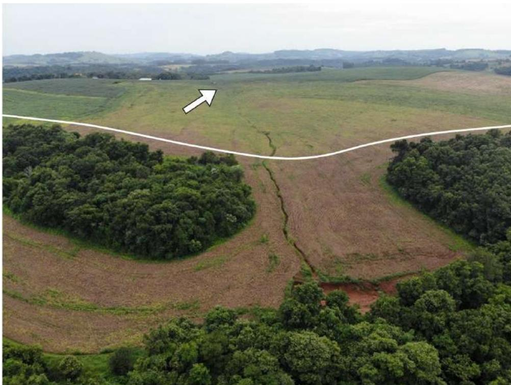
Figura 6-25: Ravina existente na encosta em área de agricultura no ponto MD 01, e fotografado com Drone em Janeiro de 2020, que apresentou aumento progressivo do processo erosivo ao longo da vertente, com agravamento em local de maior declividade, na APP do reservatório (linha branca). Seta branca indicando início do processo erosivo no alto da encosta, em propriedade particular. A erosão foi contida com a deposição de galhadas oriundas da supressão da vegetação executada em julho de 2020.
