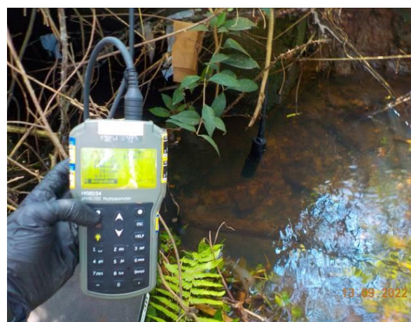
Equipamento multiparamétrico utilizado para as medições físico-químicas.
