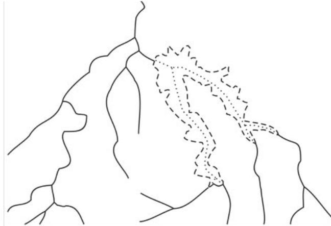
*Figura 7 - Exemplo de edição de rede hidrográfica para formato de árvore (Linha contínua- mantida a vetorização; Linha tracejada – vetorização eliminada; Linha pontilhada – vetorização inserida). Fonte: ANA.*
