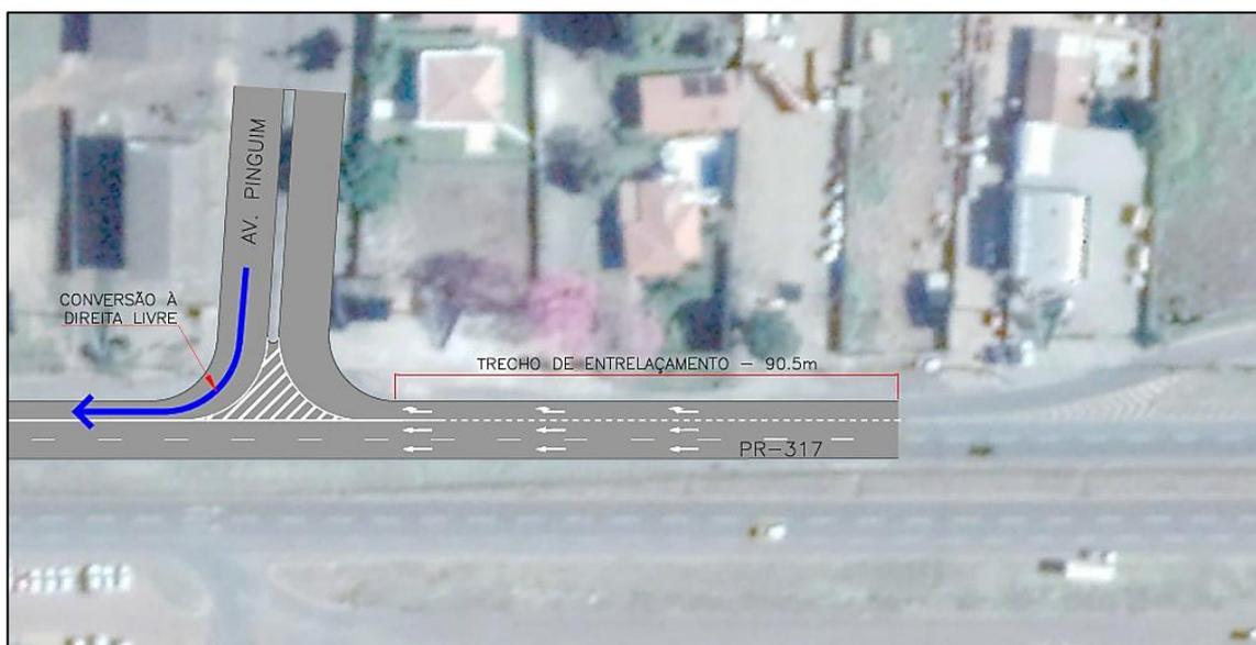
Figura 4. Proposta de retirada da sinalização de parada na interseção 1A. (Imagem: Google Earth, 2018).
