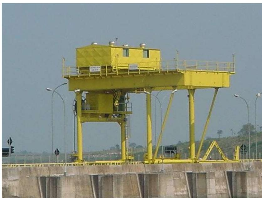
Figura 5-100: Pórtico rolante utilizado em uma usina hidrelétrica
