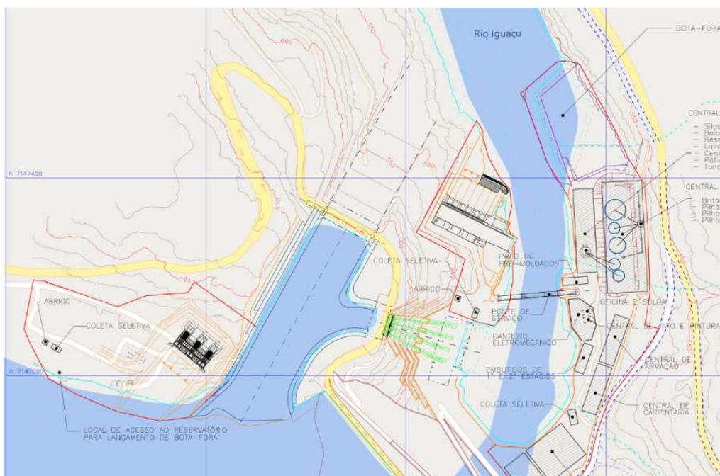
Figura 5-19 - Canteiro de Obras e Acessos - Disposição Geral
