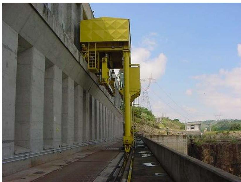
Figura 5-101: Semi-pórtico utilizado no tubo de sucção da UHE GJR
