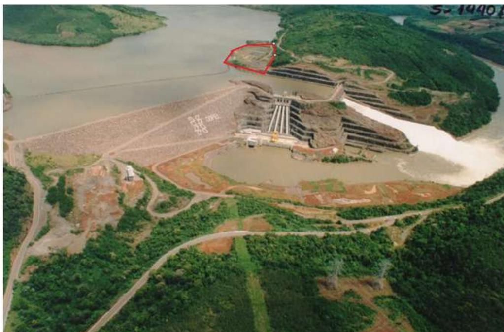
Figura 5-10: Imagem área das áreas de intervenção da UHE GNB. Na porção superior pode ser observada área aproximada a ser ocupada pela Tomada d'água e área de serviço.
