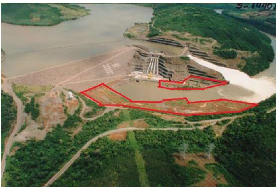
Figura 5-49: Locais de Instalação do Canteiro de Obras logo após a desmobilização das estruturas da construção (primeira sem indicação da localização do canteiro e depois com a indicação aproximada do canteiro )
