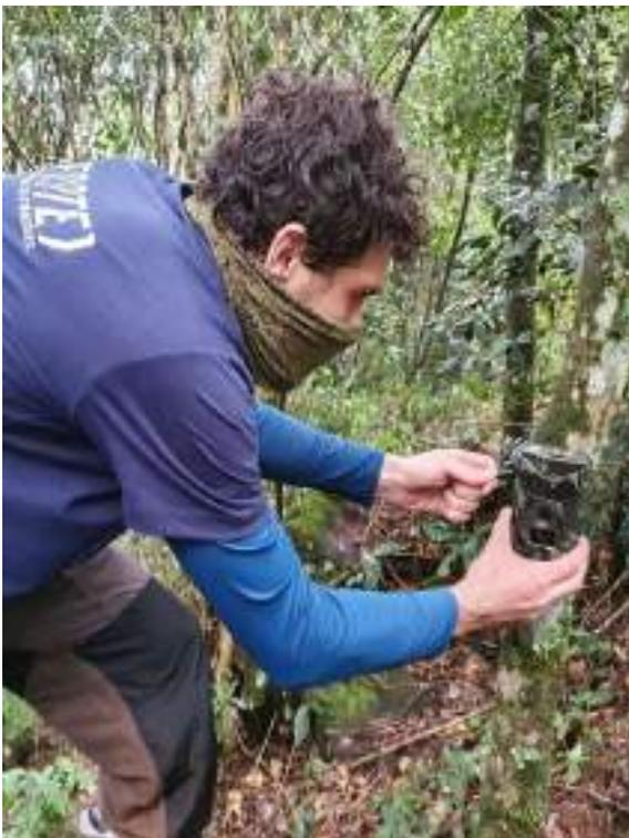
Figura 141 - Colocação das câmeras trap utilizadas para captura de mamíferos e répteis de difícil visualização durante a busca ativa. Foram instaladas uma em cada ponto de monitoramento de fauna terrestre (FT1, FT2).
