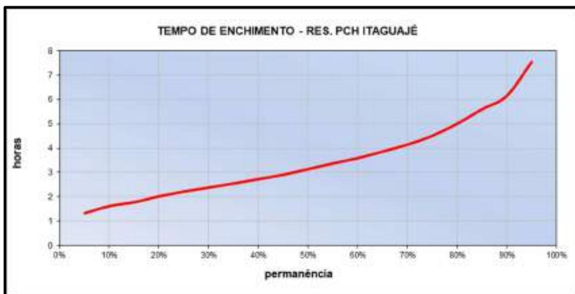
Figura 18 – Curva do tempo de enchimento do reservatório
