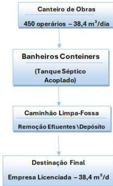
Figura 9-V: Etapas de tratamento de esgoto sanitário para o canteiro de obras
