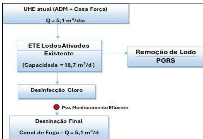
**Figura 10-IV: Ponto (P1) de monitoramento de efluentes sanitários da ETE Casa de Máquinas (atual e pós-repotenciação)**
