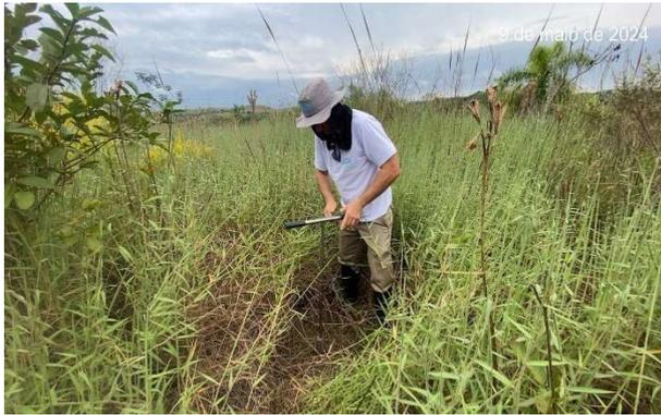
**Figura 8-XX: Utilização do trado manual na determinação de profundidade do solo na área de gramíneas.**
