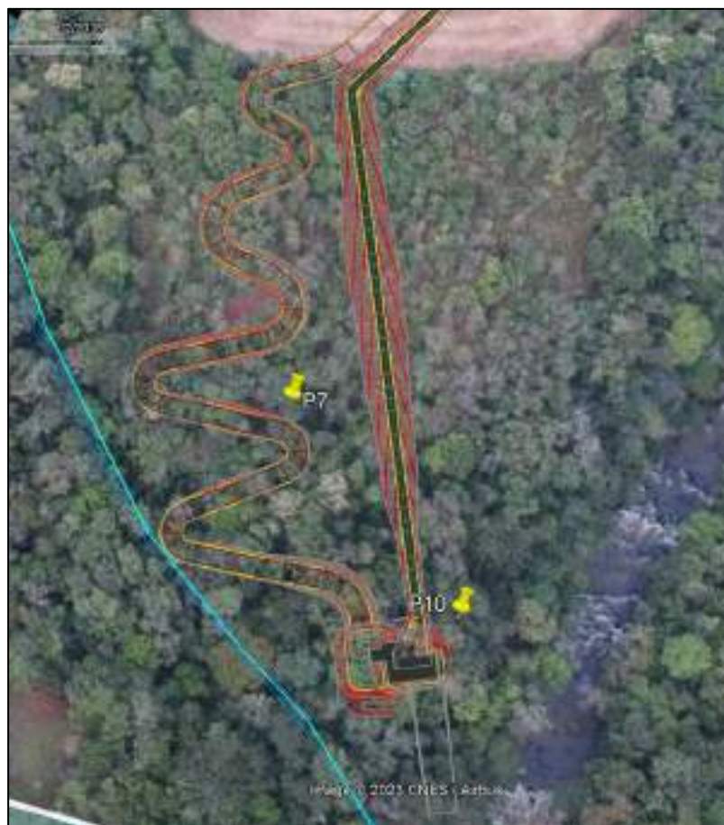
Figura 301: Sobreposição de imagem de Drone junto ao projeto no conduto forçado e casa de força.
