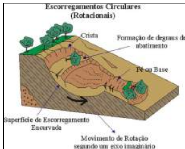
Figura 53: Escorregamento CIRCULAR ou ROTACIONAL, apresenta superfície de deslizamento encurvada, correspondendo a movimento rotacional, segundo um eixo. Ocorre geralmente em aterros, pacotes de solo ou depósitos mais espessos, rochas sedimentares ou cristalinas intensamente fraturadas.
