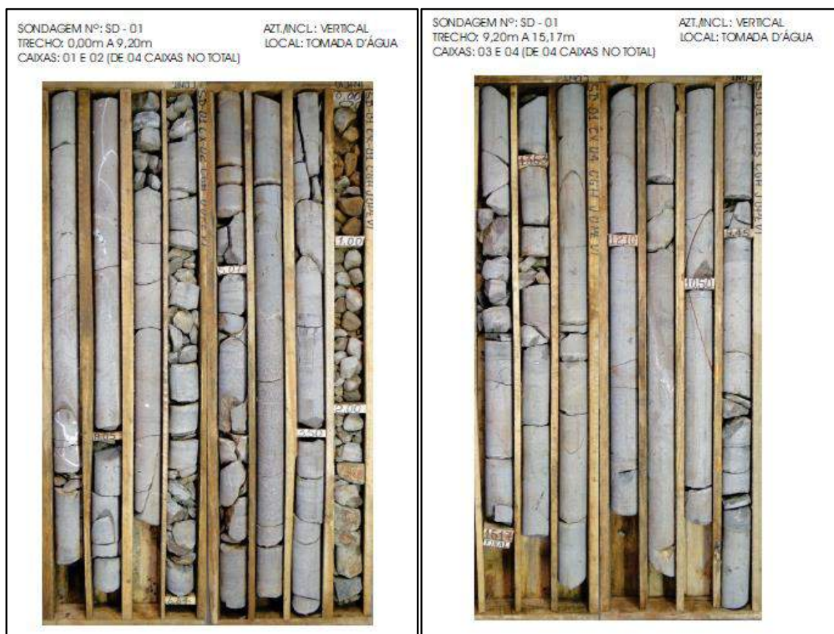
Figura 43: Corpo de prova da sondagem rotativa da tomada d'água – SD-01.
