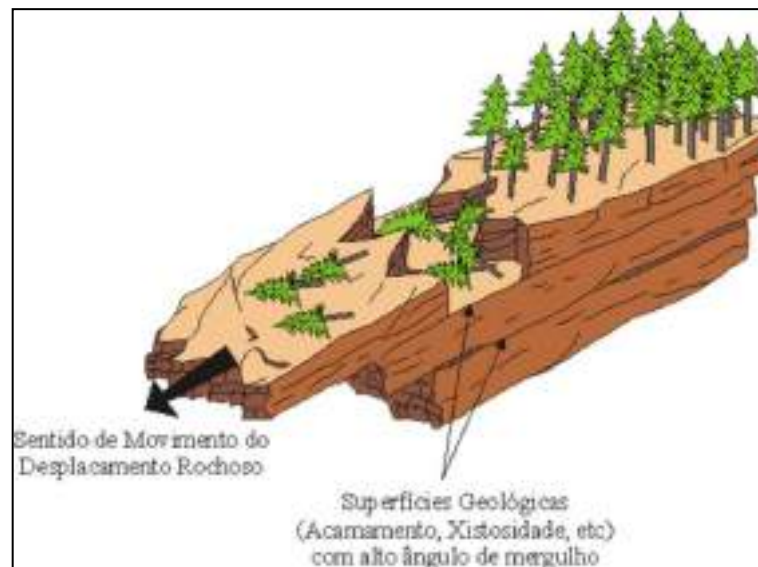
Figura 50: O desprendimento por DESPLACAMENTO, consiste em movimento em queda livre ou por deslizamento de blocos rochosos, ao longo de superfícies estruturais (xistosidade, acamamento), que ocorre devido às variações térmicas ou por alívio de pressão.
