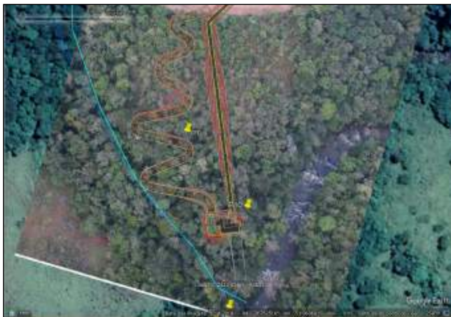
Figura 300: Sobreposição de imagem de Drone e Google Earth junto ao projeto no conduto forçado e casa de força.
