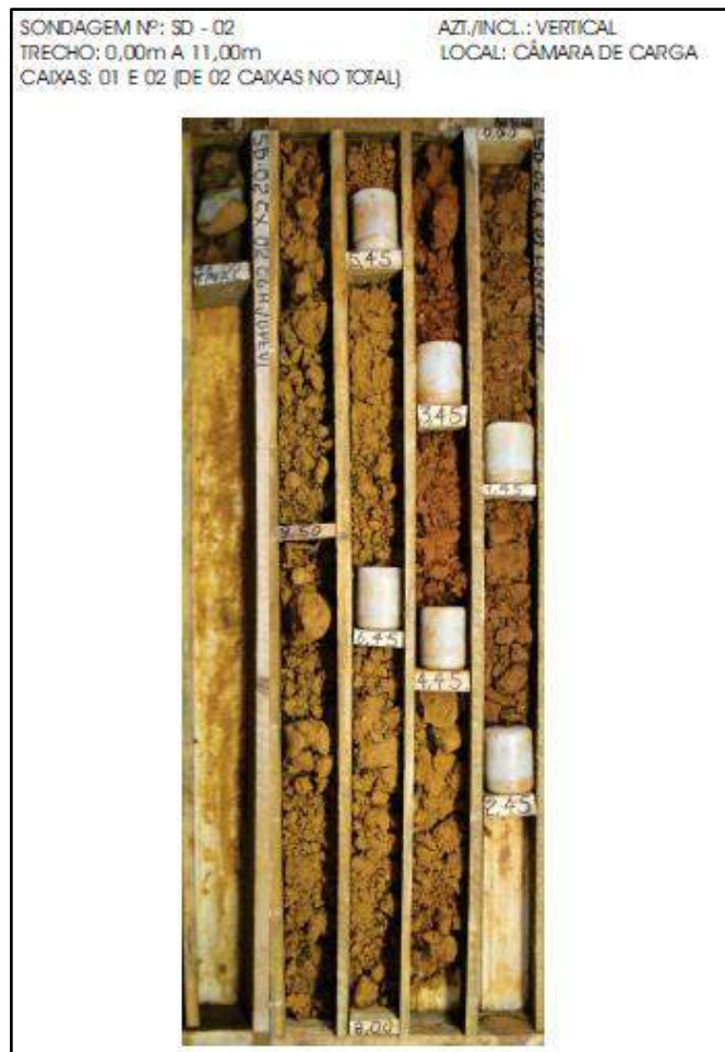
Figura 44: Corpo de prova da sondagem rotativa da câmara de carga – SD-02.
