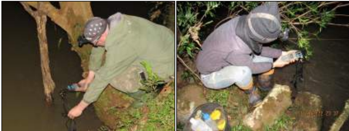
Figura 166: Medição das variáveis ambientais com o multiparâmetro.
