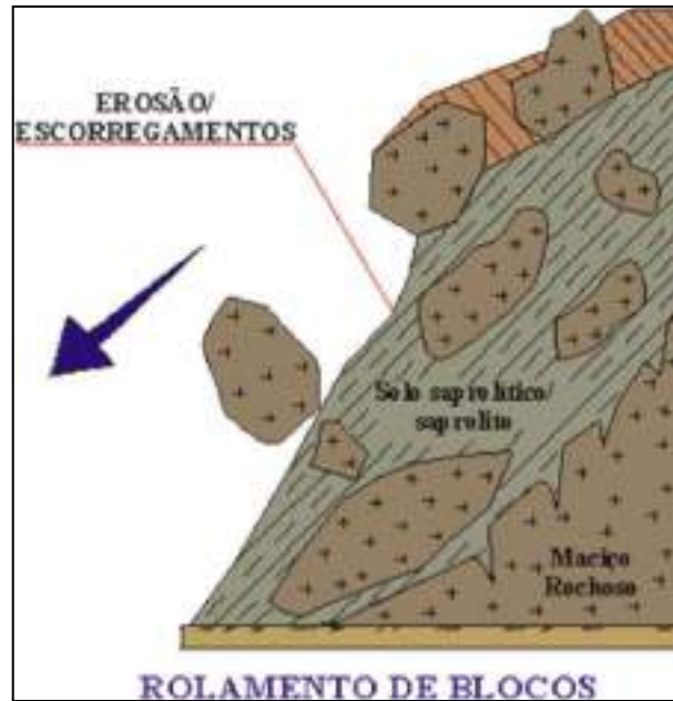
Figura 49: O desprendimento por ROLAMENTO DE BLOCOS, consiste em movimento de blocos rochosos ao longo de encostas, o que geralmente ocorrer pela perda de apoio.
