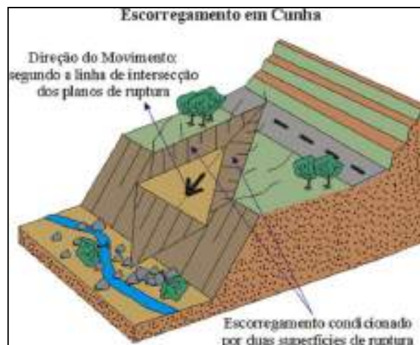
Figura 51: Escorregamento em CUNHA, consiste em movimento ao longo de um eixo formado pela intersecção de estruturas planares em maciços rochosos, que desloca o material em forma de prisma. São comuns em taludes de corte ou encostas que sofreram algum tipo de desconfinamento, natural ou antrópico.
