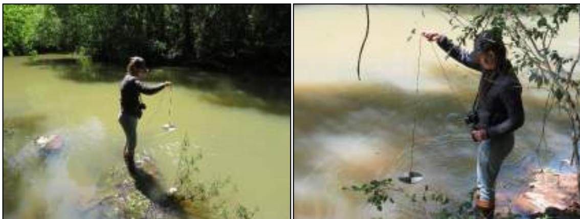
Figura 167: Medição da turbidez da água com o disco de Secchi.
