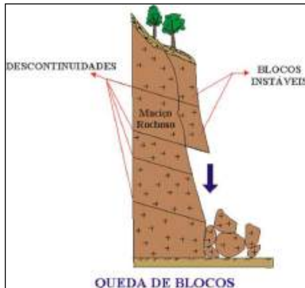
Figura 48: O desprendimento por QUEDA DE BLOCOS, consiste em blocos de rochas que se desprendem do maciço e se deslocam em queda livre encosta abaixo, podendo ocorrer em volumes e litologias diversas.
