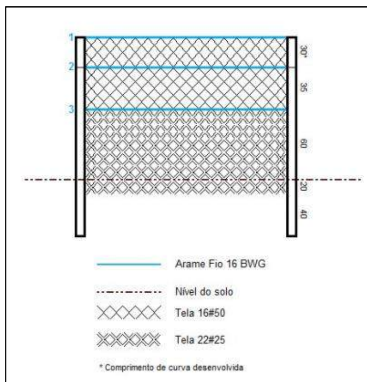
Figura 339: Modelo de cerca guia para ser implantado no entorno do canal. Fonte: DNIT, 2018.
