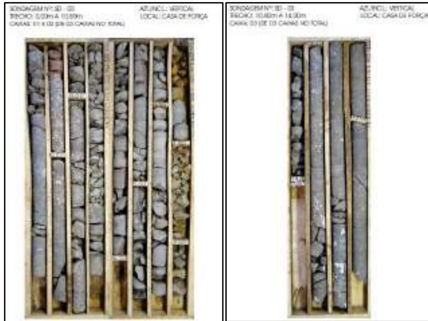
Figura 45: Corpo de prova da sondagem rotativa da casa de força – SD-03.
