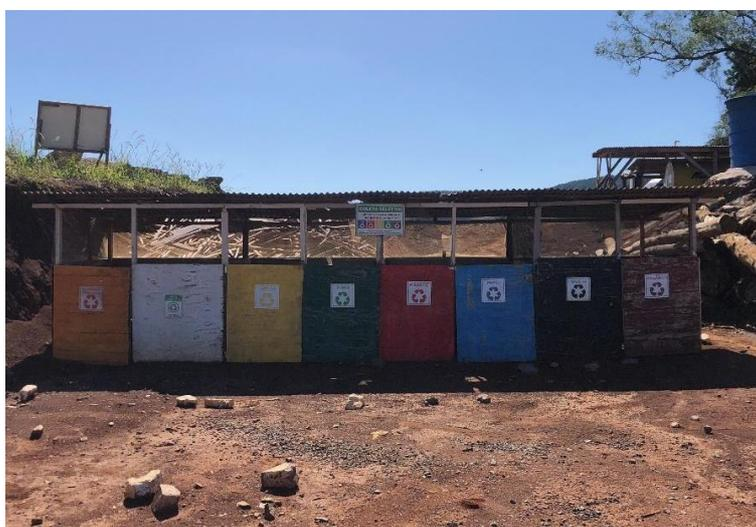
Figura 51 – Exemplos de Área de Armazenamento Temporário de Resíduos da Construção Civil.
