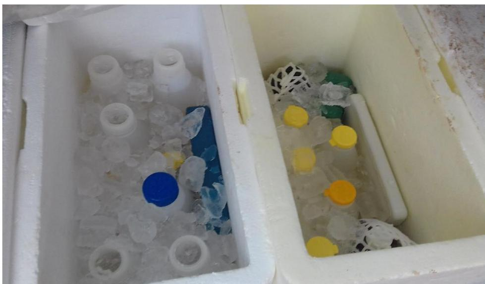
Figura 56 – Exemplo de Acondicionamento Correto de Amostras.
