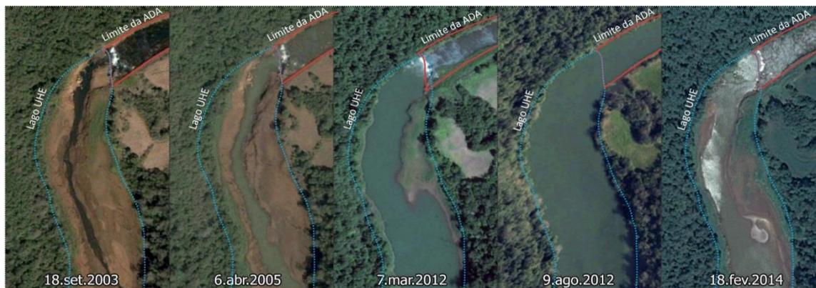
Figura 25 - Variação do Rio Tapera devido ao reservatório da UHE de Salto Santiago.
