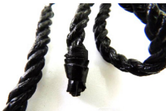
Figura 24: Amostra nº 5, apresentando o sentido de torção das fibras em "Z", contendo uma falça de acabamento na ponta
