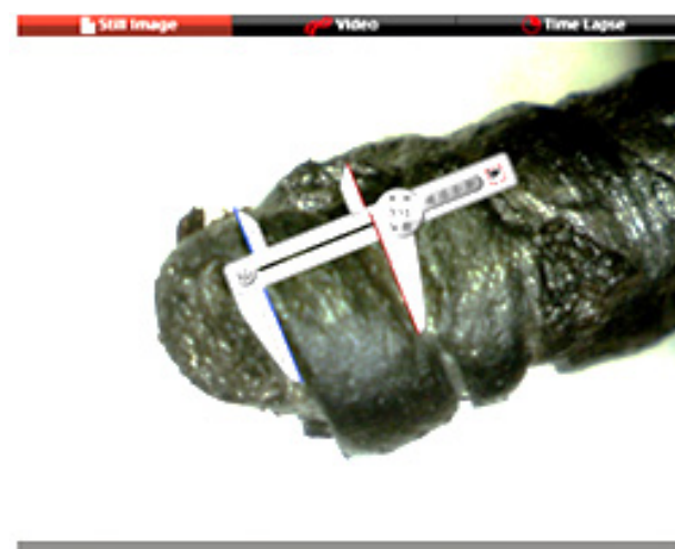
Figura 26: Amostra 5 - Corda com três fibras torcidas, acabamento tipo falça, medição com software ProScope HR, utilizando microscópio digital de 20x
