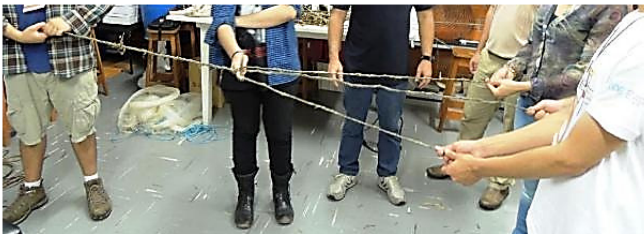
Figura 31: Fase de torção das três fibras da casca do cipó-imbé, na fabricação da corda, com o uso de um separador em Y (galho de madeira)
