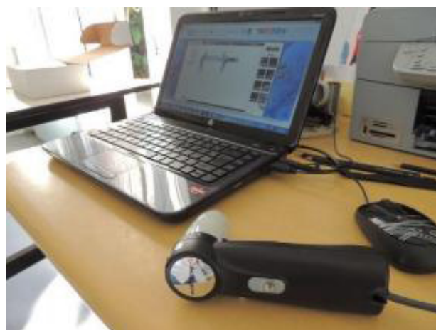
Figura 4: Equipamentos para análise e medição (microscópio portátil eletrônico 40x)
