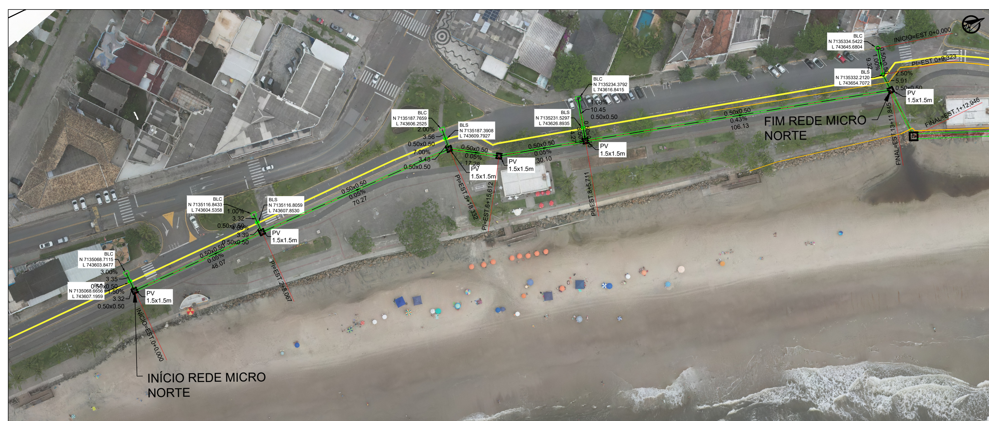
PLANTA MICRODRENAGEM REDE NORTE ESC 1:750
