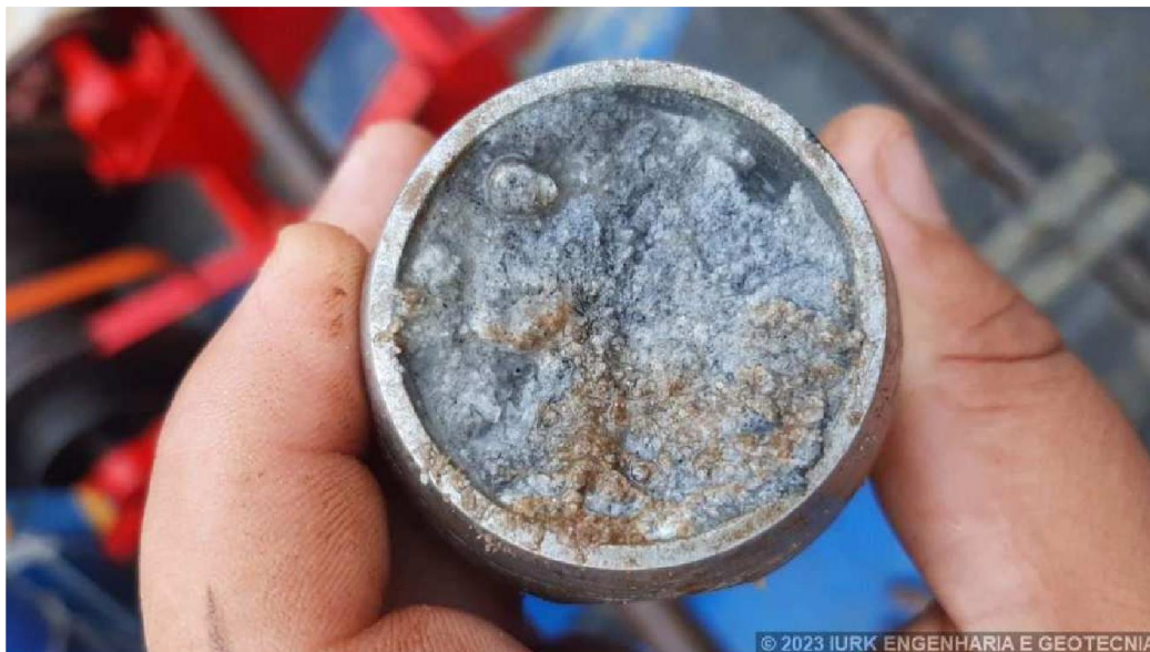
Foto 2 – SM-6.21: Bico do amostrador - 26 m - Silte com areia grossa cinza esverdeado
