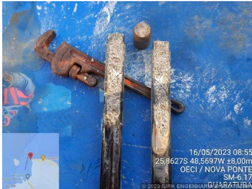
Foto 3 – SM-6.17: Silte argiloarenoso com feições de alteração de rocha.
