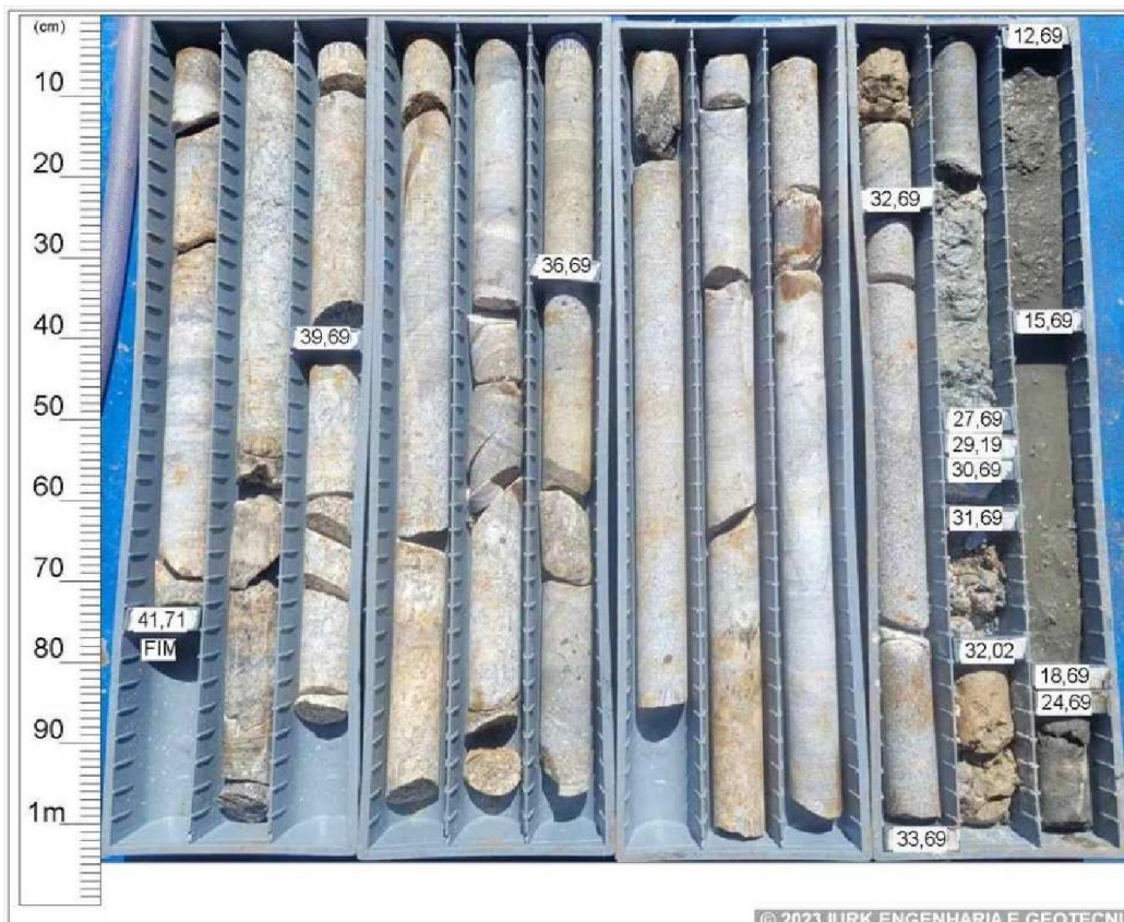
Foto 3 – SM-6.21: Caixas de testemunhos
