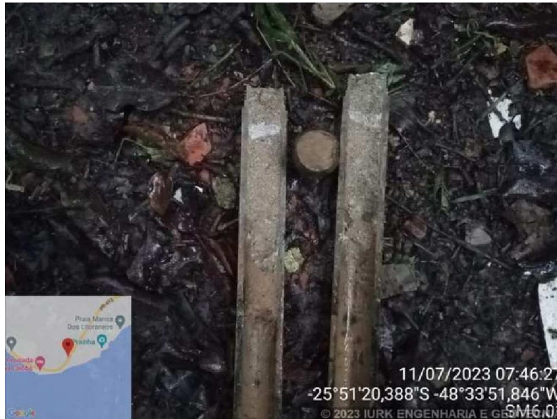
Foto 1 – SM-6.01: Areia siltosa cinza. Solo residual
