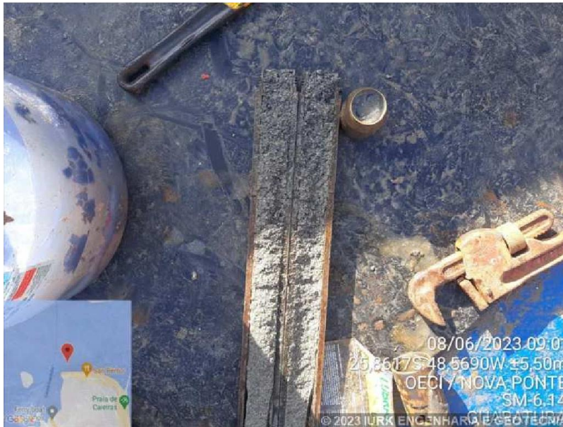
Foto 1 – SM-6.14: Silte arenoso cinza com conchas marinhas. 24,52 - 24,97 m.
