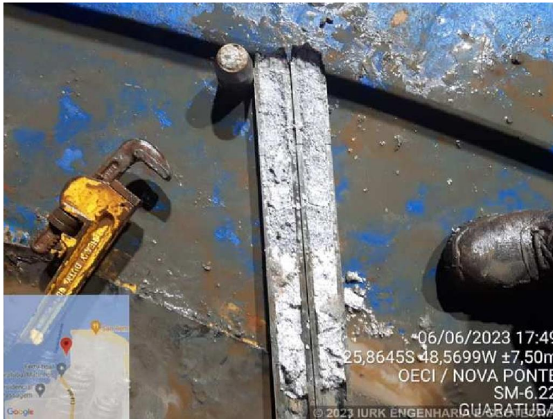
Foto 3 – SM-6.22: Areia média siltosa com feições de alteração de rocha. 21,00 - 21,45 m
