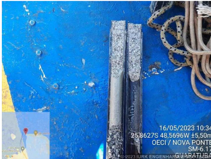
Foto 1 – SM-6.17: Silte arenoso cinza com estrutura reliquia - alteração de rocha.
