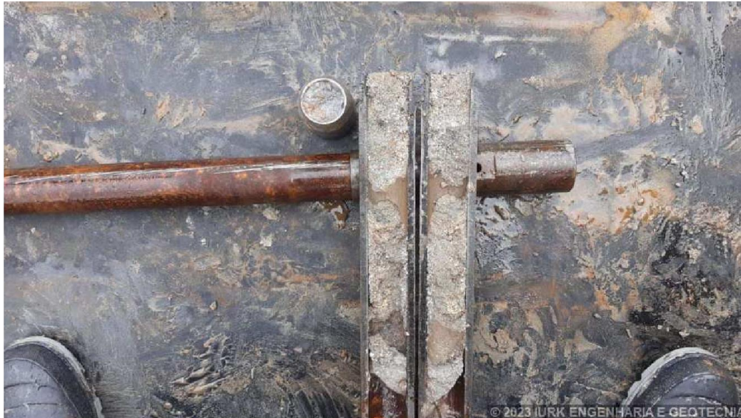
Foto 1 – SM-6.21: Silte com areia grossa cinza esverdeado (26 m)
